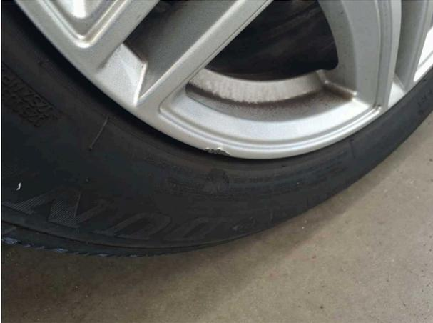
**Beschädigung #1:** Rad/Reifen: Leichtmetallfelge hinten rechts - verkratzt / verschürft - kein Abzug
