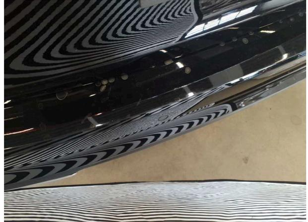
**Beschädigung #6:** Stossfänger hinten: Stossfänger hinten - Delle / Lackschaden - instandsetzen und lackieren
