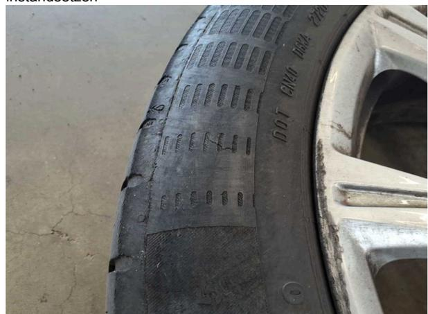
**Beschädigung #5:** 2.Radsatz: 1 Reifen - beschädigt - erneuern
