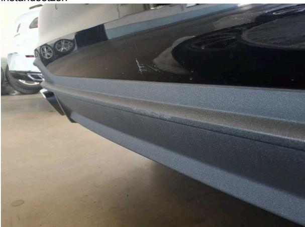
**Beschädigung #4:** Stossfänger hinten: Spoiler - Abrieb - erneuern
