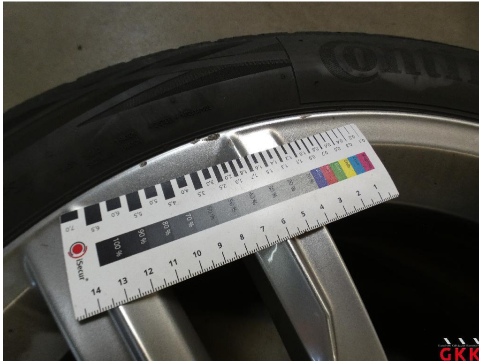
Bild 17 LM-Rad, 2 x beiliegend, beschädigt, Smartrepair
