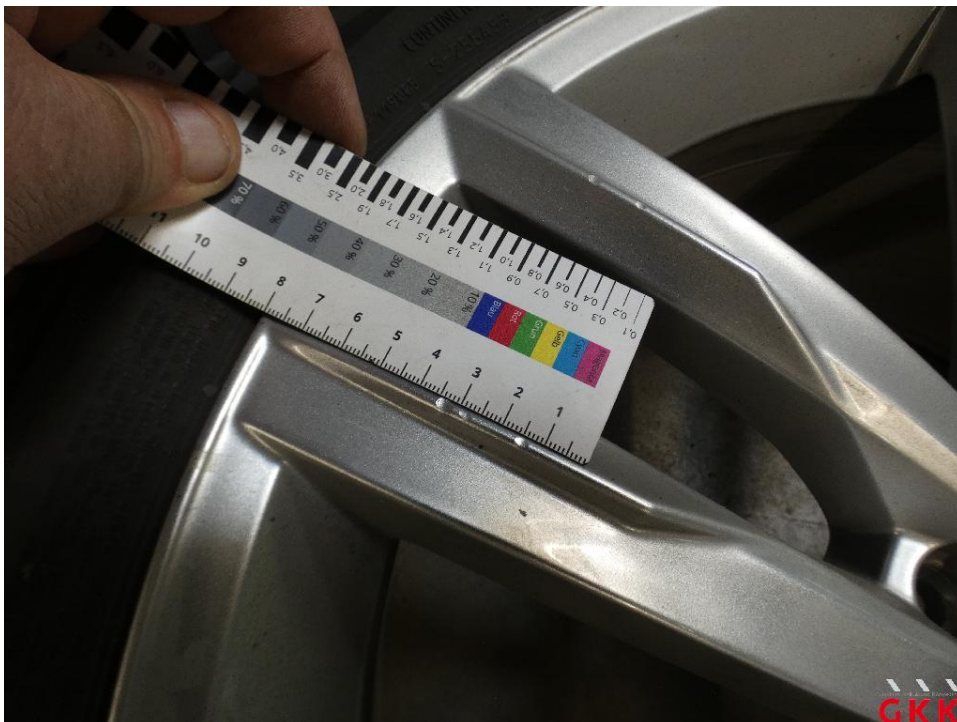
Bild 16 LM-Rad, 2 x beiliegend, beschädigt, Smartrepair
