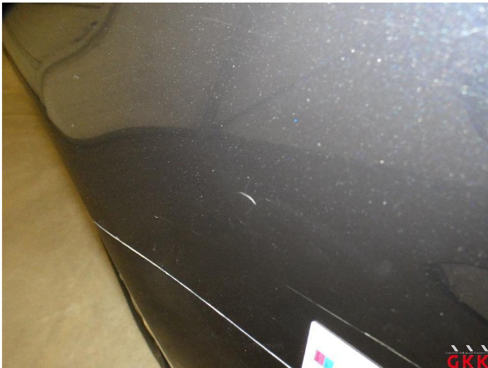
Bild 20 Seitenwand links, verkratzt, lackieren
