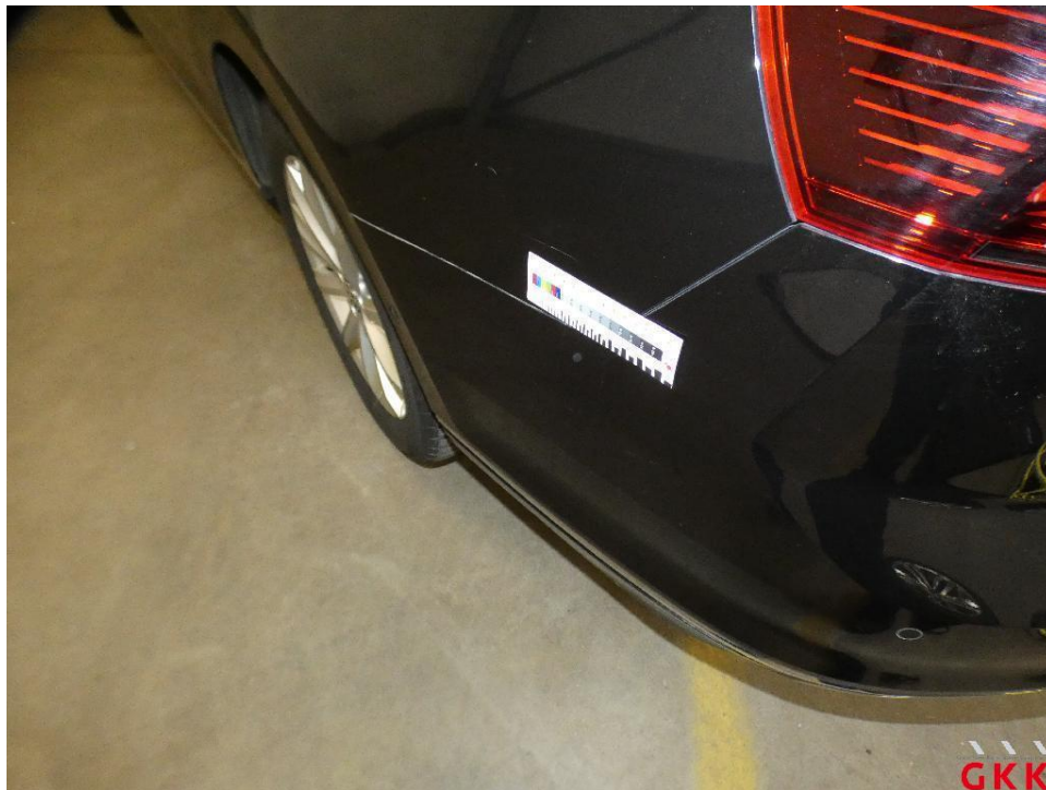
Bild 18 Seitenwand links, verkratzt, lackieren
