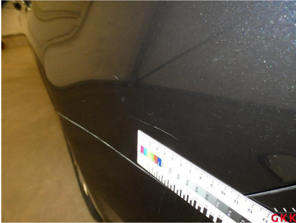
Bild 19 Seitenwand links, verkratzt, lackieren
