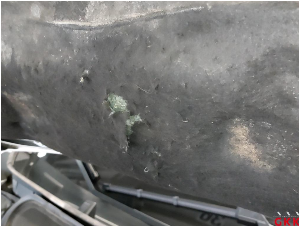
Bild 15 Motorhaube, Dämmmatte, beschädigt, ersetzen
