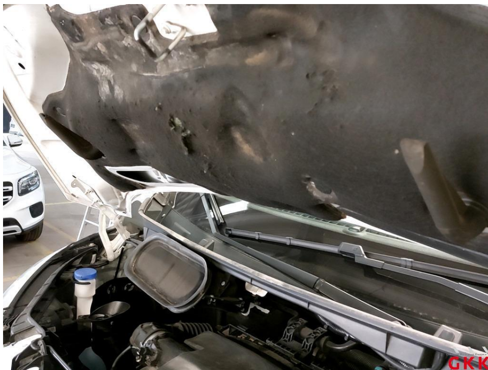
Bild 14 Motorhaube, Dämmmatte, beschädigt, ersetzen
