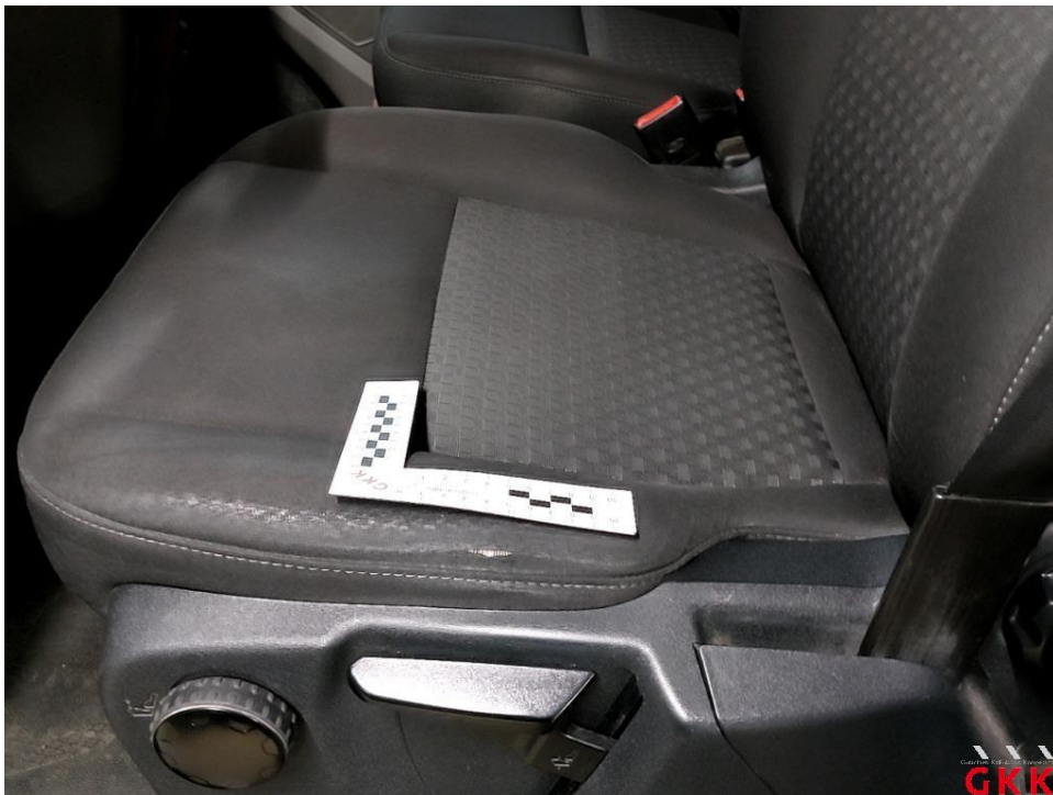
Bild 24 Sitz vorne links, Bezug Sitzkissen -Stoff-, gerissen, ersetzen
