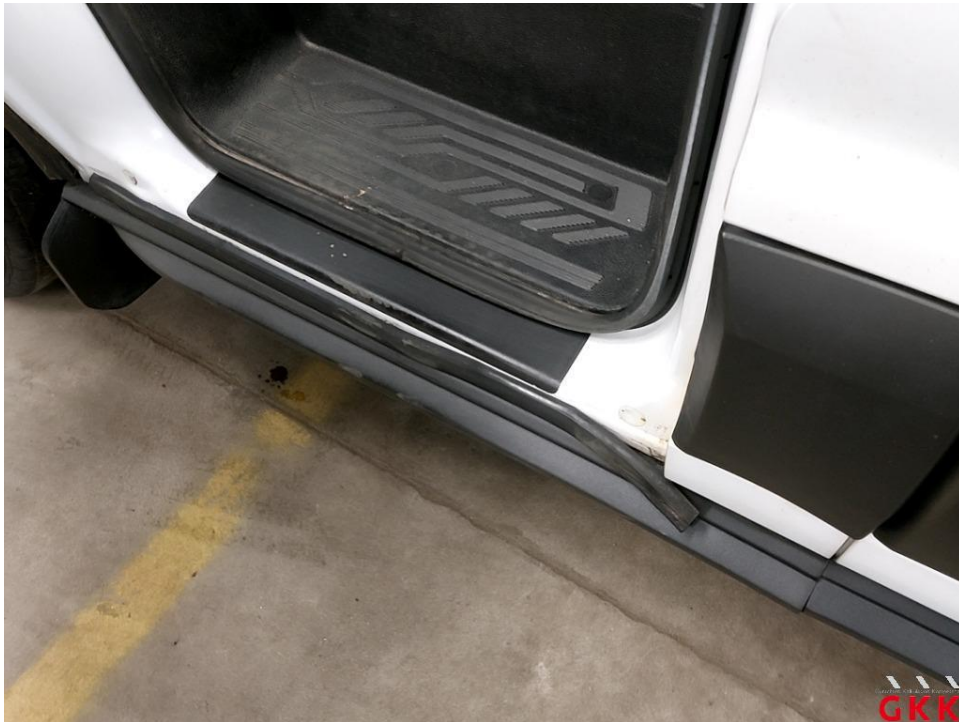
Bild 35 Tür vorne links, Dichtung -Einstieg-, lose, ersetzen
