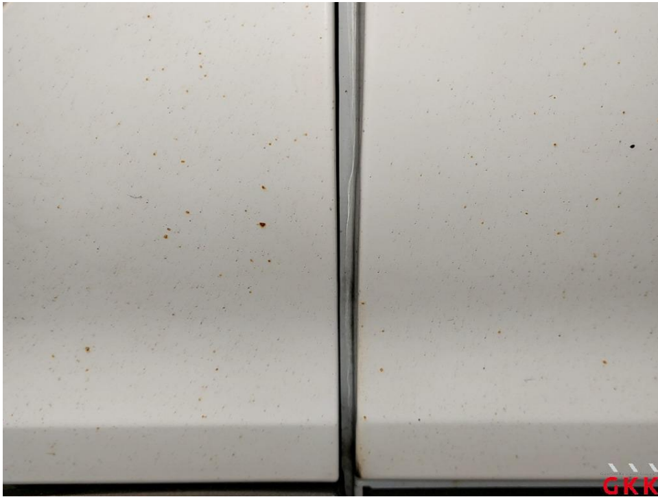
Bild 23 Fahrzeug, außen, Lackierung verwittert / matt, aufbereiten
