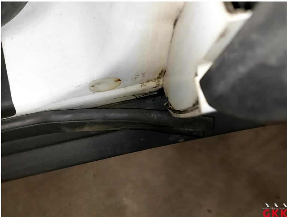
Bild 36 Tür vorne links, Dichtung -Einstieg-, lose, ersetzen
