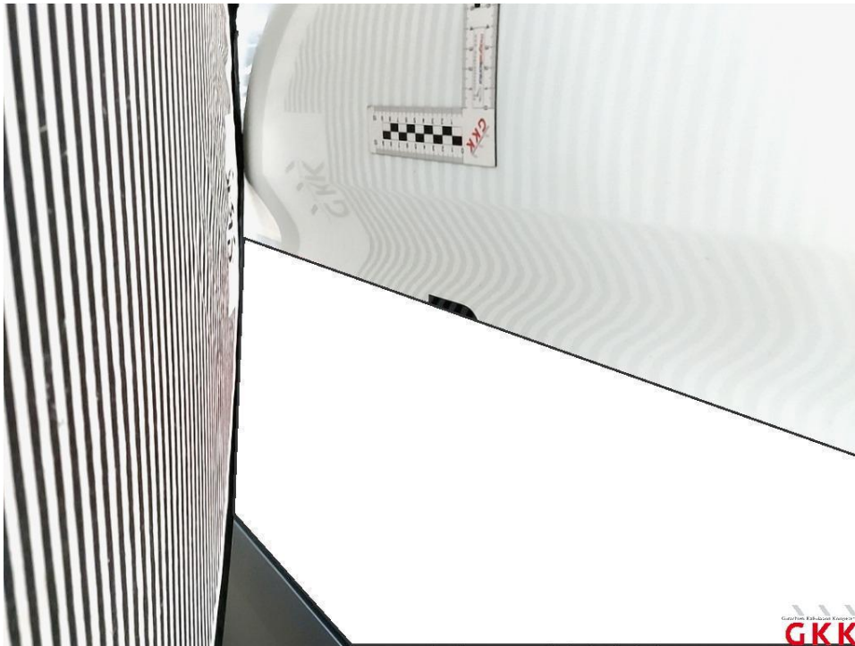
Bild 31 Schiebetür rechts, beschädigt, instand setzen - lackieren
