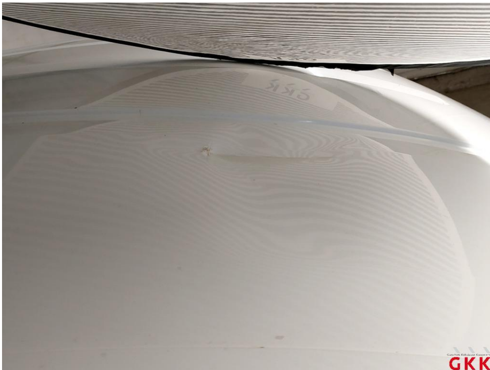
Bild 20 Dach, beschädigt, instand setzen - lackieren
