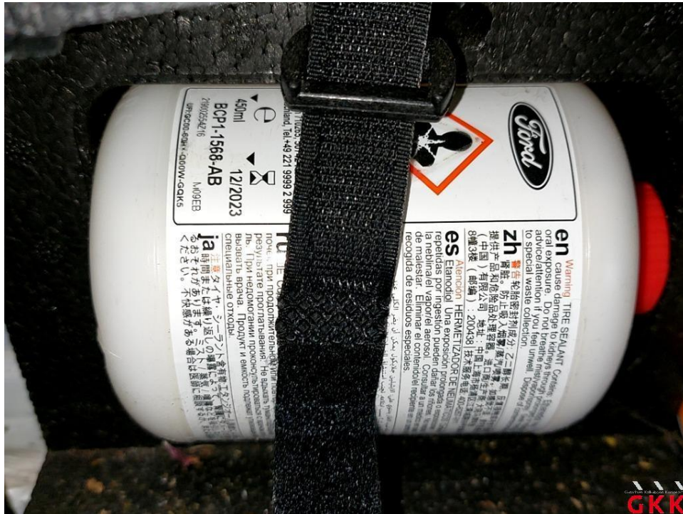
Bild 21 Reifenreparaturset, Füllflasche, MHD überschritten, ersetzen
