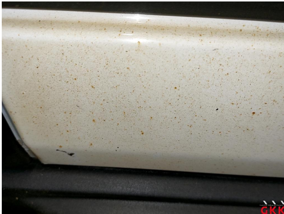
Bild 22 Fahrzeug, außen, Lackierung verwittert / matt, aufbereiten
