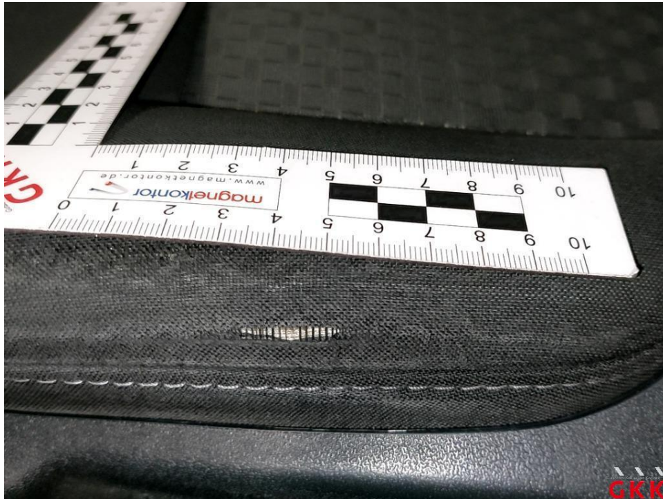
Bild 25 Sitz vorne links, Bezug Sitzkissen -Stoff-, gerissen, ersetzen
