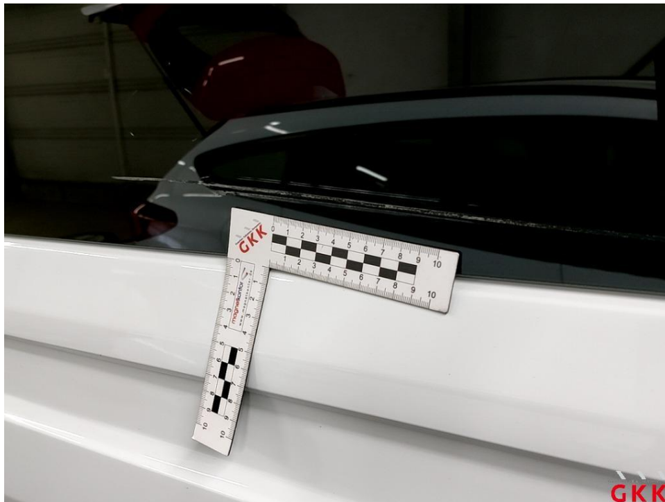
Bild 34 Seitenwand links, Scheibe -getönt-, verkratzt, ersetzen
