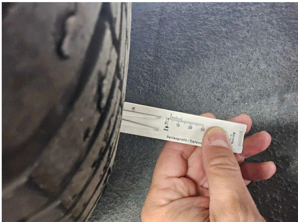
Bild 16 : 2 Reifen an der Vorderachse unter 4 mm und Aussenschulterverschleiß
