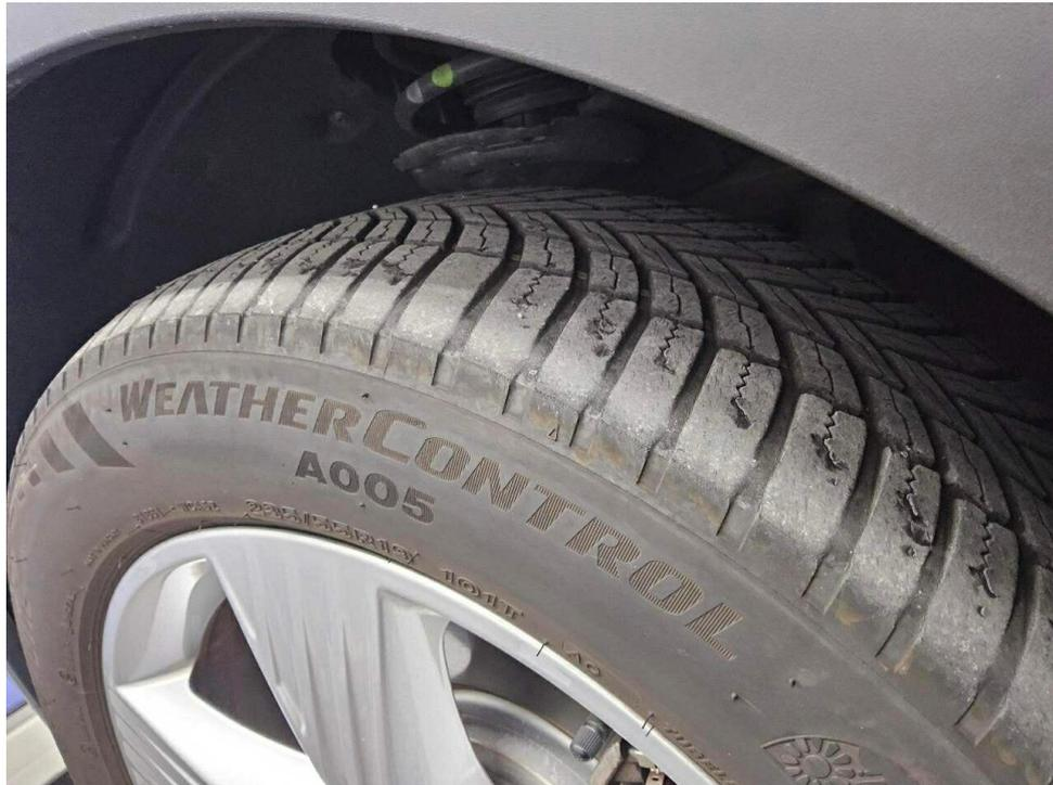
Bild 17 : 2 Reifen an der Vorderachse unter 4 mm und Aussenschulterverschleiß
