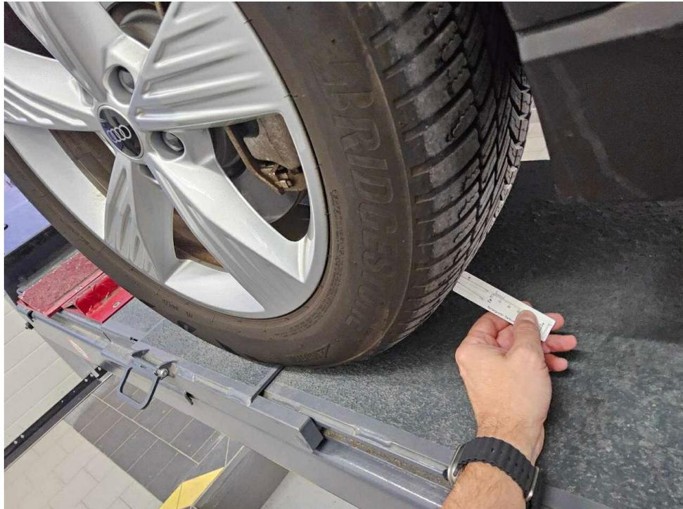
Bild 15 : 2 Reifen an der Vorderachse unter 4 mm und Aussenschulterverschleiß
