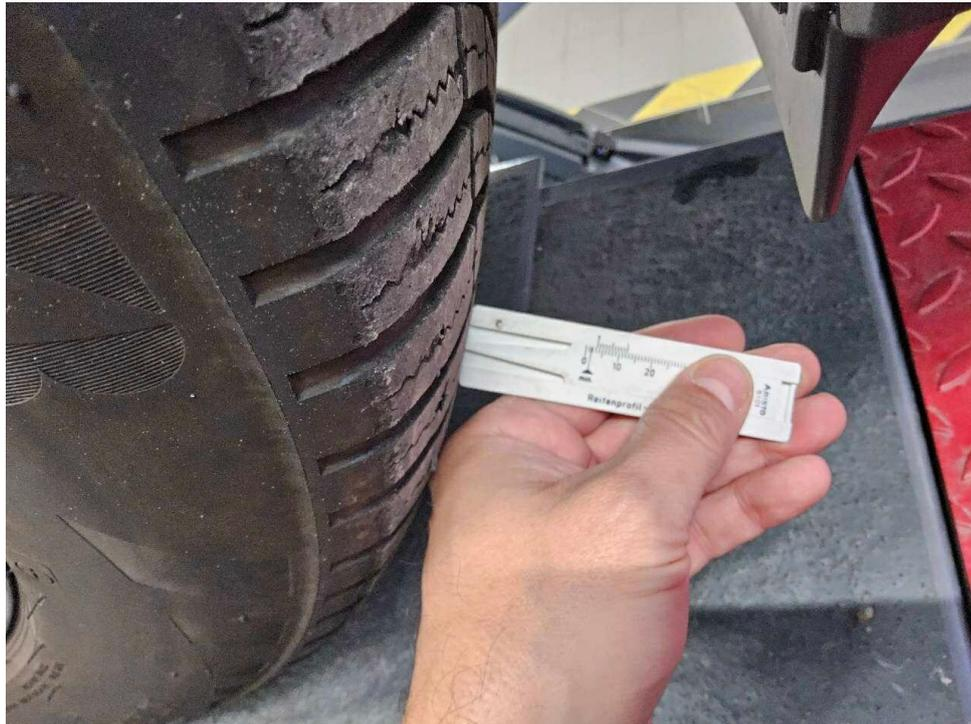
Bild 19 : 2 Reifen an der Vorderachse unter 4 mm und Aussenschulterverschleiß
