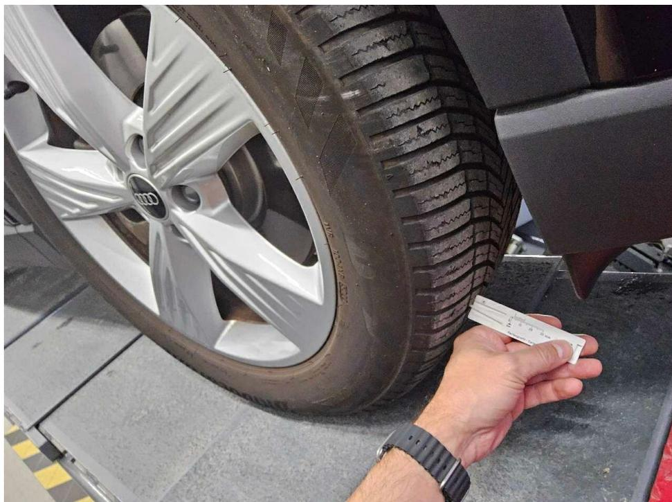
Bild 18 : 2 Reifen an der Vorderachse unter 4 mm und Aussenschulterverschleiß
