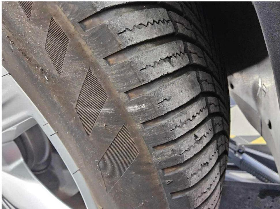
Bild 20 : 2 Reifen an der Vorderachse unter 4 mm und Aussenschulterverschleiß
