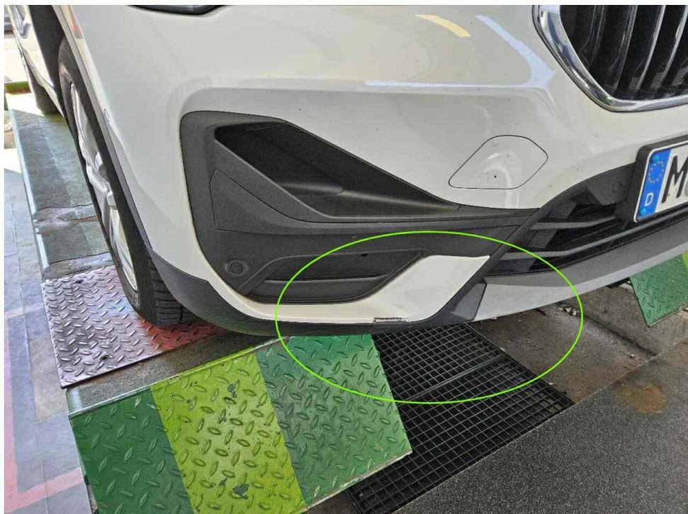
Bild 18 : Frontstoßfänger rechts verschrammt und verformt
