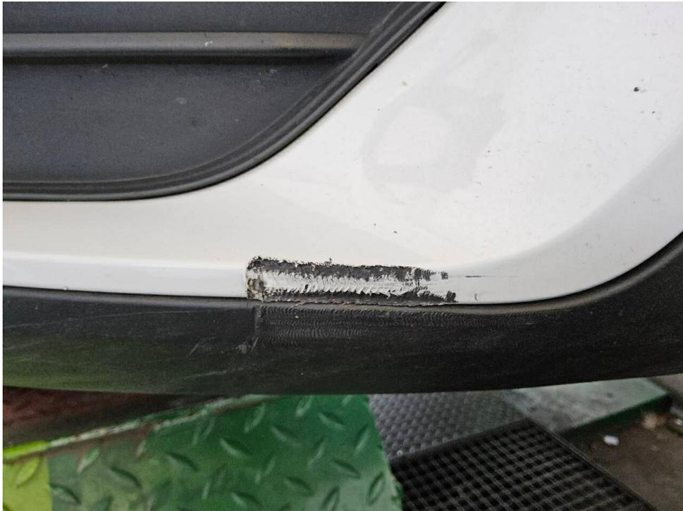
Bild 19 : Frontstoßfänger rechts verschrammt und verformt
