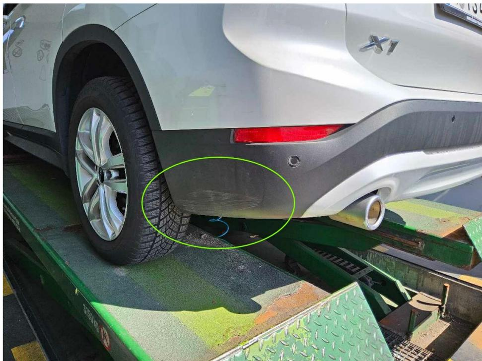
Bild 14 : Stoßfängerabdeckung hinten links, verschrammt
