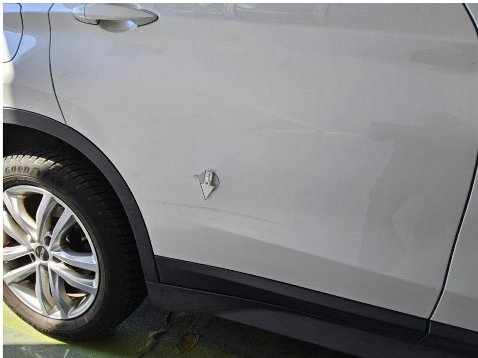
Bild 21 : Tür hinten rechts Lackierung, verschrammt, lackieren
