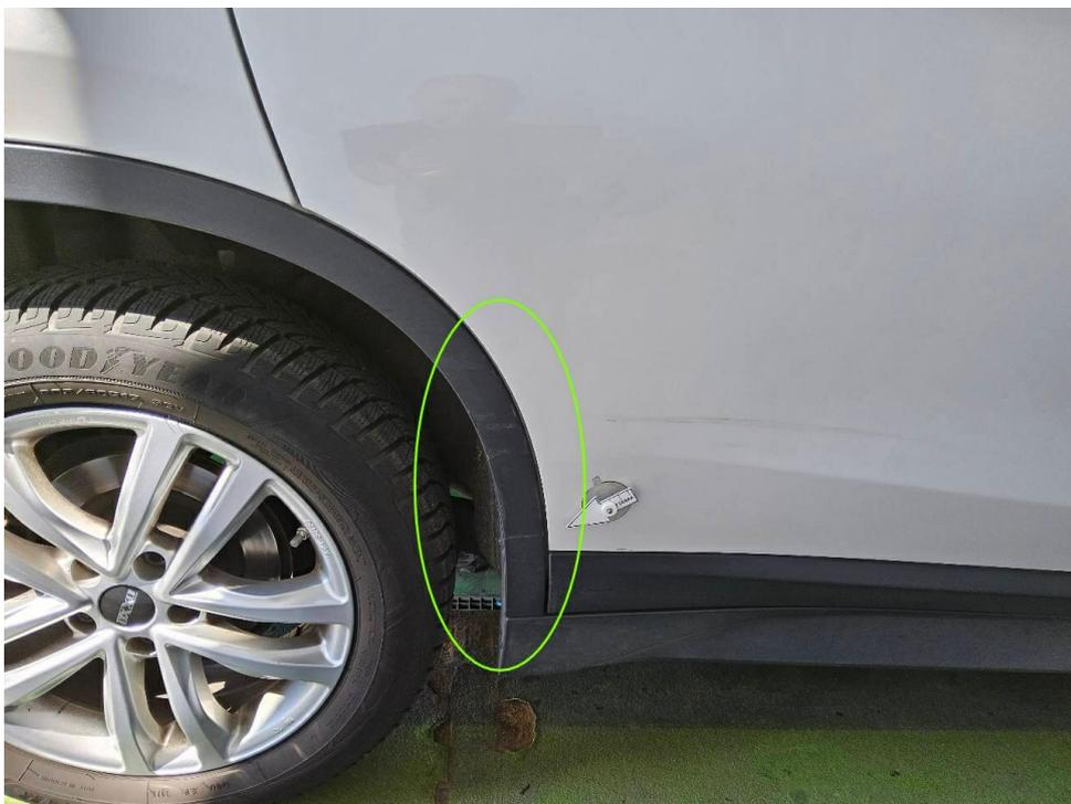
Bild 16 : Radlaufverbreiterung hinten rechts, verschrammt
