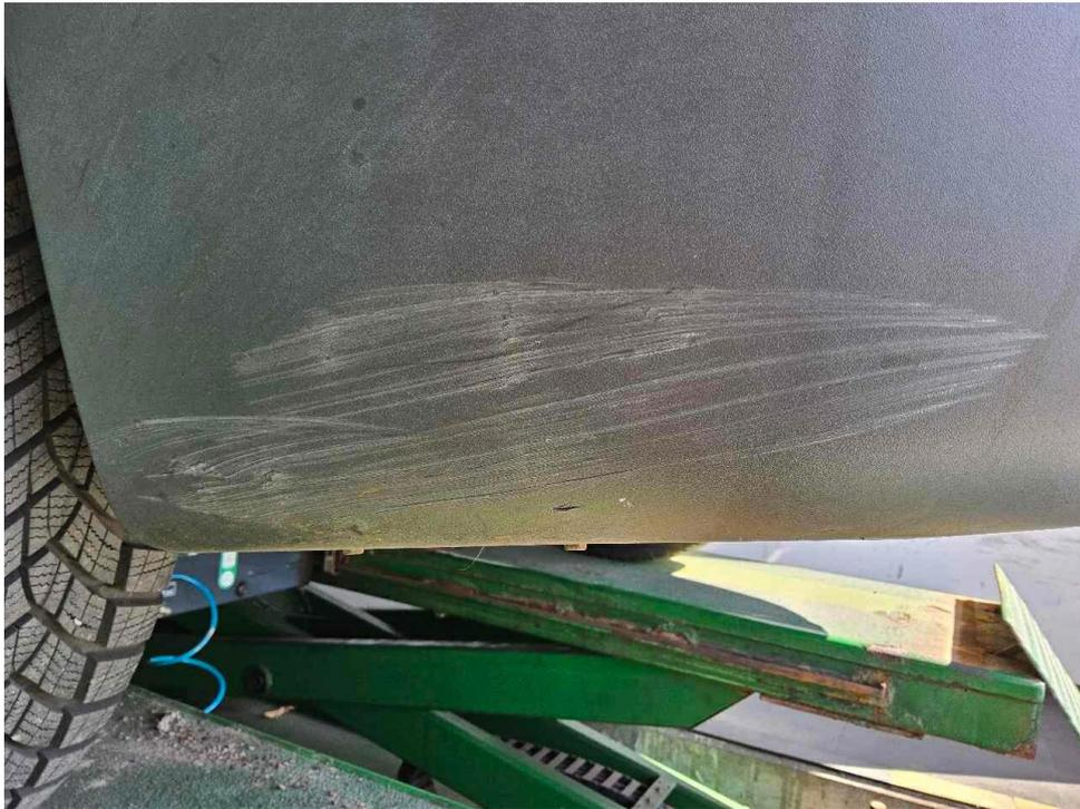
Bild 15 : Stoßfängerabdeckung hinten links, verschrammt
