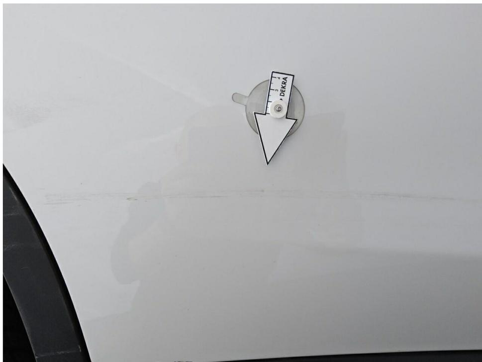
Bild 22 : Tür hinten rechts Lackierung, verschrammt, lackieren
