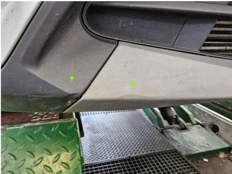
Bild 20 : Frontstoßfänger rechts verschrammt und verformt
