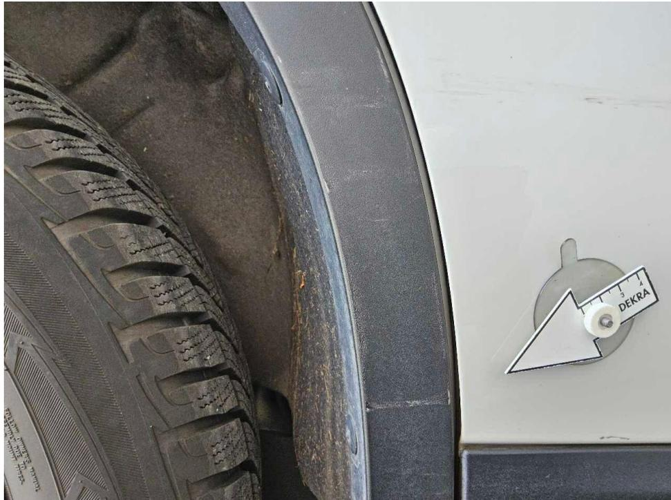
Bild 17 : Radlaufverbreiterung hinten rechts, verschrammt
