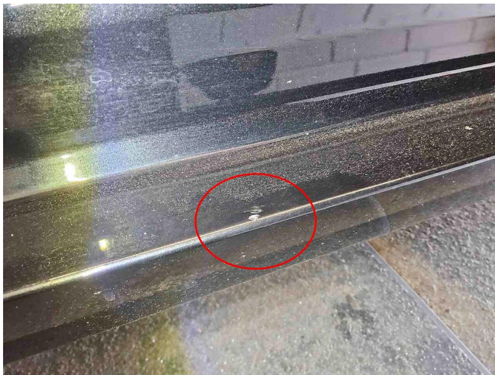
Bild 16 : Stoßfänger hinten Lackierung, verschrammt, Gebrauchsspur
