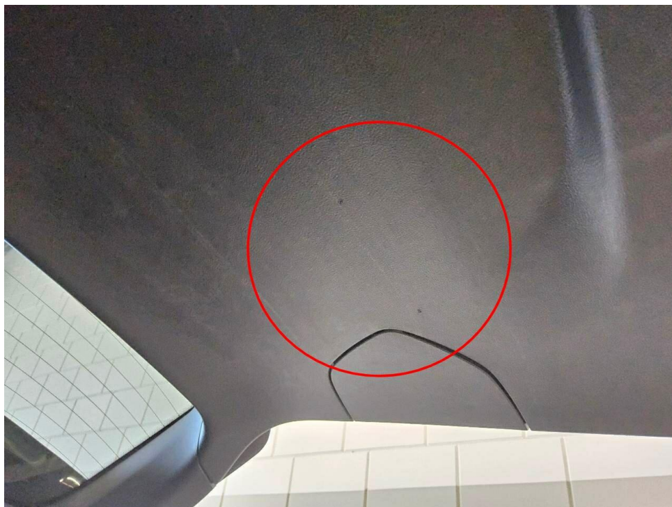
Bild 17 : Verkleidung Heckklappe, verschrammt, Gebrauchsspur
