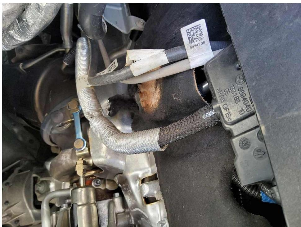
Bild 12 : Dämmmatte Motor Tierverbiss
