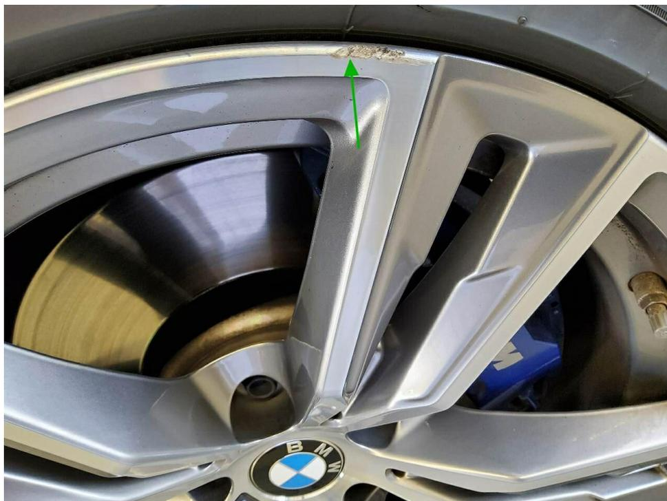
Bild 14 : Glanzgedrehte Felge vorne links zerkratzt
