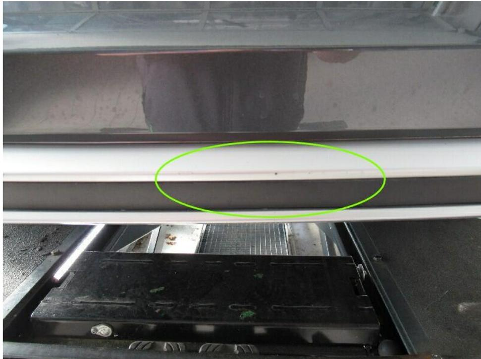
Bild 15 : Spoiler hinten verschrammt
