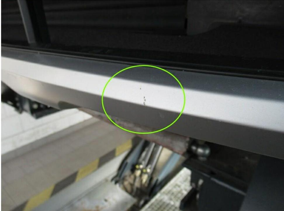
Bild 17 : Spoiler vorne verschrammt
