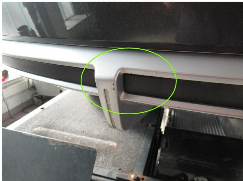
Bild 14 : Spoiler hinten verschrammt
