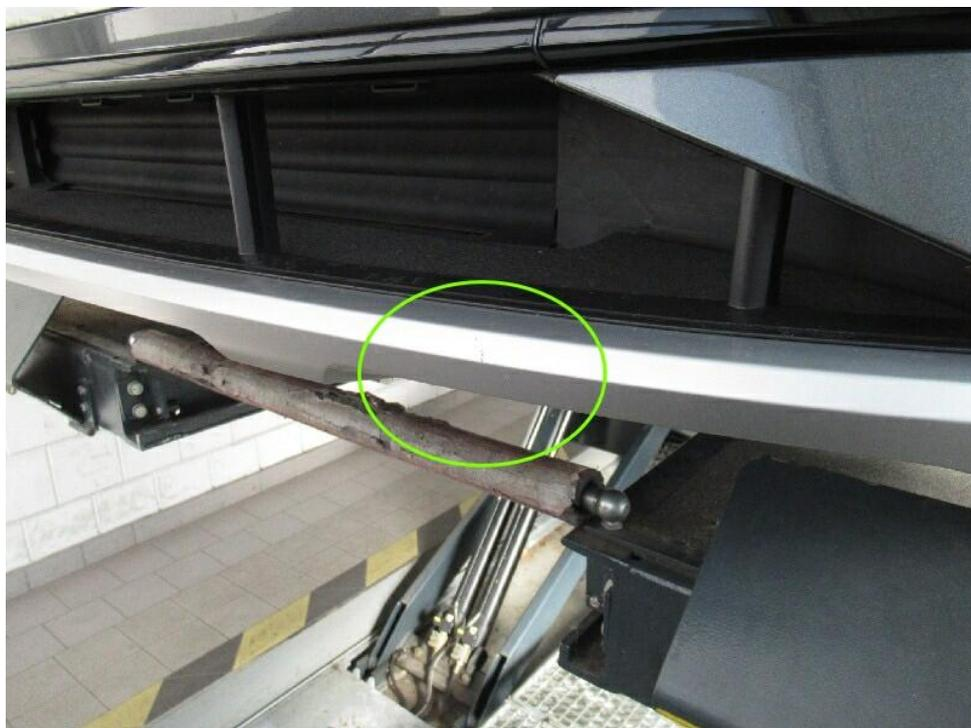
Bild 16 : Spoiler vorne verschrammt
