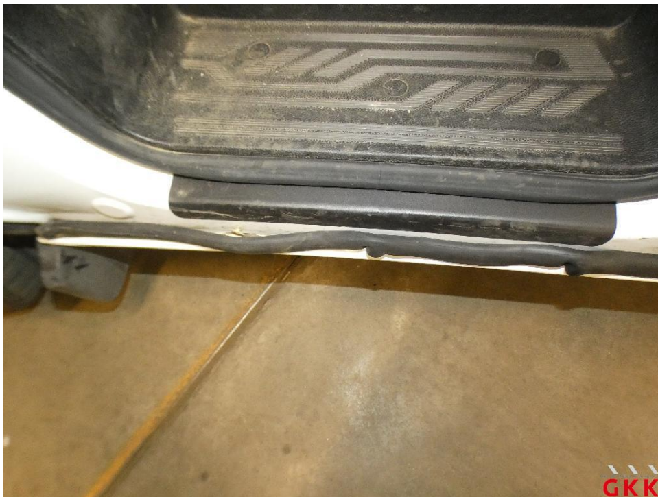
Bild 14 Tür vorne links, Dichtung -Einstieg-, beschädigt, ersetzen
