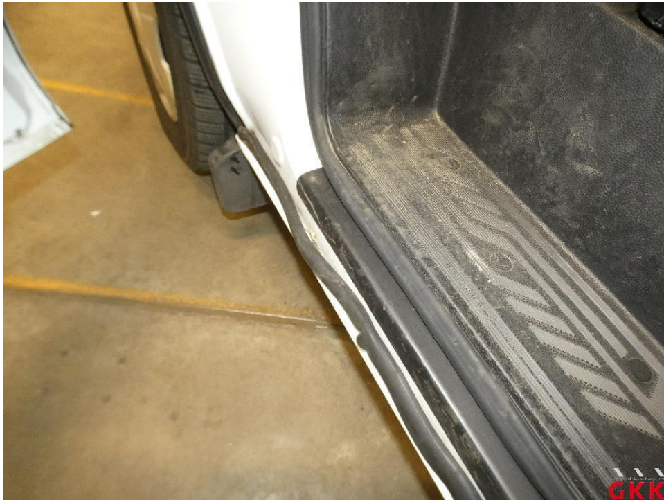
Bild 15 Tür vorne links, Dichtung -Einstieg-, beschädigt, ersetzen
