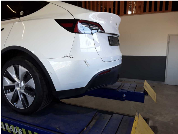
Beschädigung #10: Stossfänger hinten: Stossfänger hinten - Kratzer - instandsetzen und lackieren
