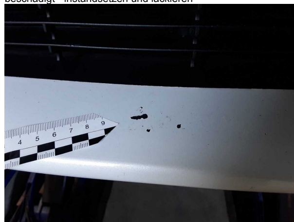
Beschädigung #11: Stossfänger vorn: Stossfänger vorn - beschädigt - instandsetzen und lackieren
