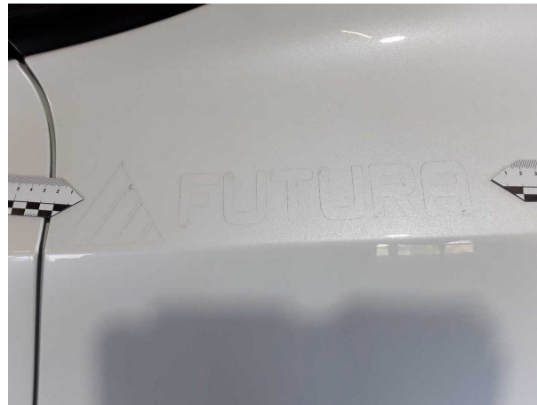
Beschädigung #1: Seitenwand links: Seitenwand - beklebt/ beschriftet - entkleben/neutralisieren
