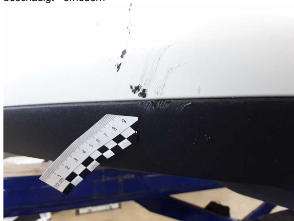
Beschädigung #9: Stossfänger vorn: Spoiler (Verkleidung unten) - beschädigt - erneuern
