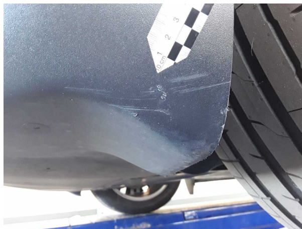
Beschädigung #9: Stossfänger vorn: Spoiler (Verkleidung unten) - beschädigt - erneuern
