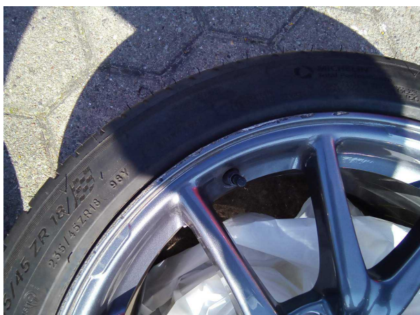
Beschädigung #7: 2.Radsatz: 2 Leichtmetallfelgen - Kratzer - erneuern
