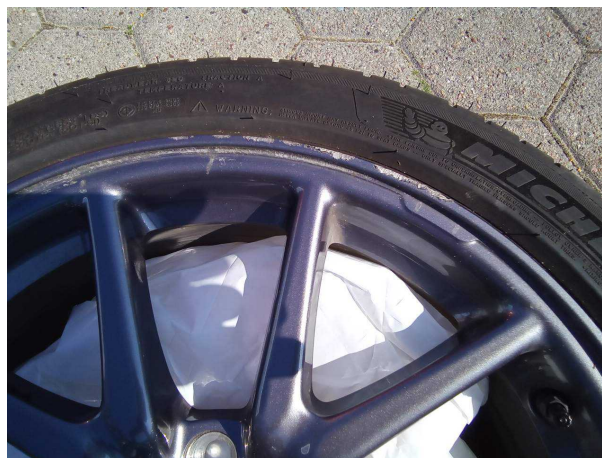
Beschädigung #7: 2.Radsatz: 2 Leichtmetallfelgen - Kratzer - erneuern
