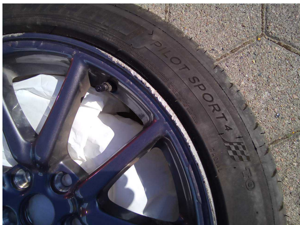
Beschädigung #7: 2.Radsatz: 2 Leichtmetallfelgen - Kratzer - erneuern
