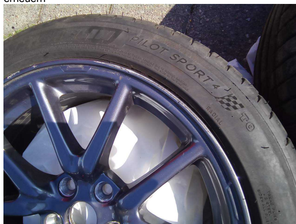
Beschädigung #7: 2.Radsatz: 2 Leichtmetallfelgen - Kratzer - erneuern
