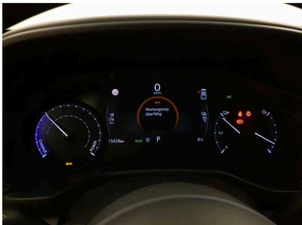
**Abbildung 19:** Kombiinstrument
