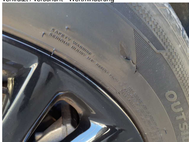
Beschädigung #2: Rad/Reifen: Reifen vorn rechts - beschädigt - erneuern
