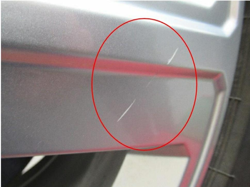
Bild 15 : Felge vorne rechts Lackierung, verschrammt, lackieren
