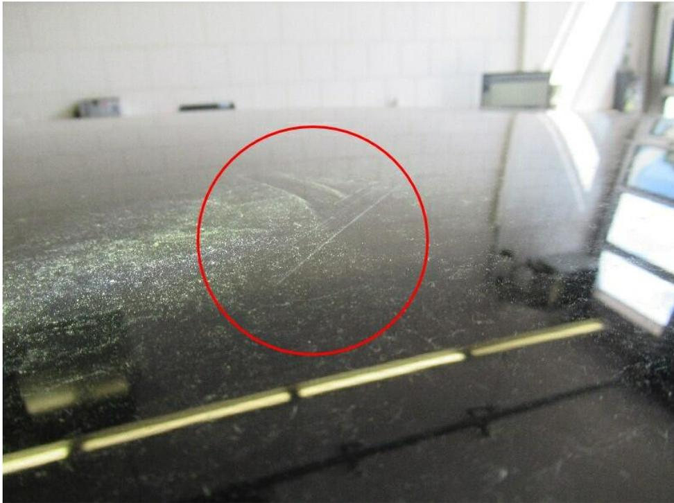
Bild 17 : Dach verschrammt
