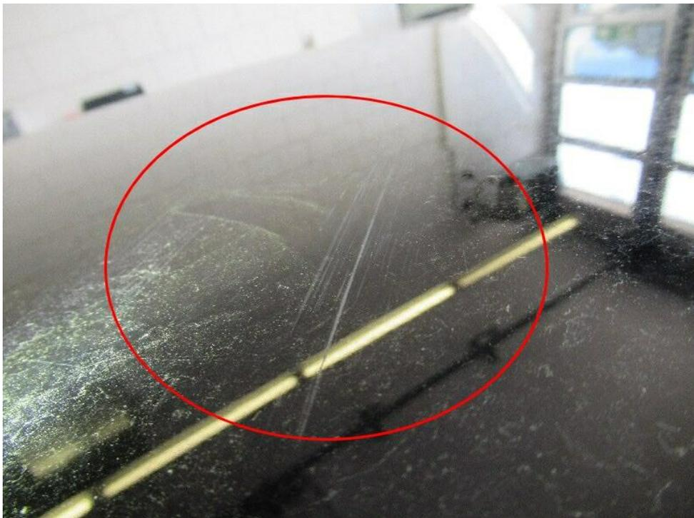
Bild 18 : Dach verschrammt
