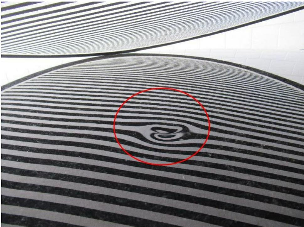
Bild 16 : Dach, eingedellt, instandsetzen und lackieren mit Lackaufbau
