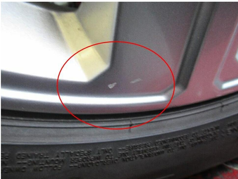
Bild 14 : Felge vorne rechts Lackierung, verschrämmt, lackieren
