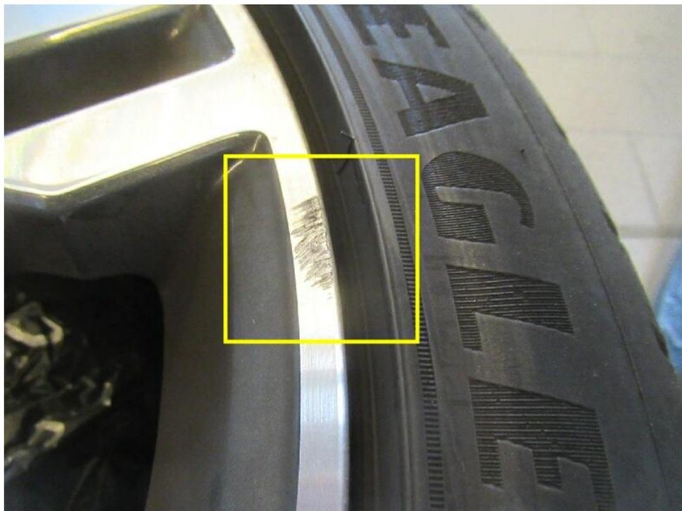
Bild 21 : Glanzgedrehte Felge Sommerradsatz vorne links verkratzt mit Materialabtrag
