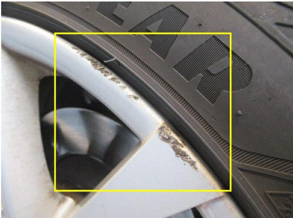
Bild 24 : Felge vorne rechts Lackierung, zerkratzt, smart repair
