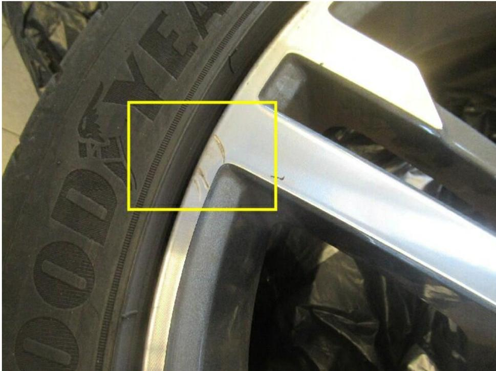
Bild 23 : Glanzgedrehte Felge Sommerradsatz vorne links verkratzt mit Materialabtrag
