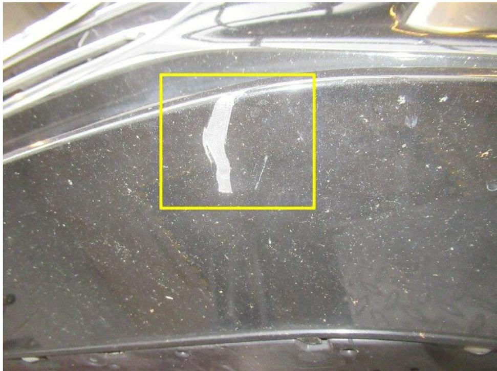
Bild 17 : Stoßfänger vorne Lackierung, zerkratzt, smart repair
