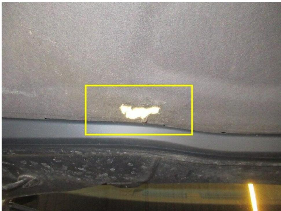
Bild 18 : Motorhaubendämmung, Motorabdeckung und Hitzeschutzverkleidung Unterboden mit Marderverbiss
