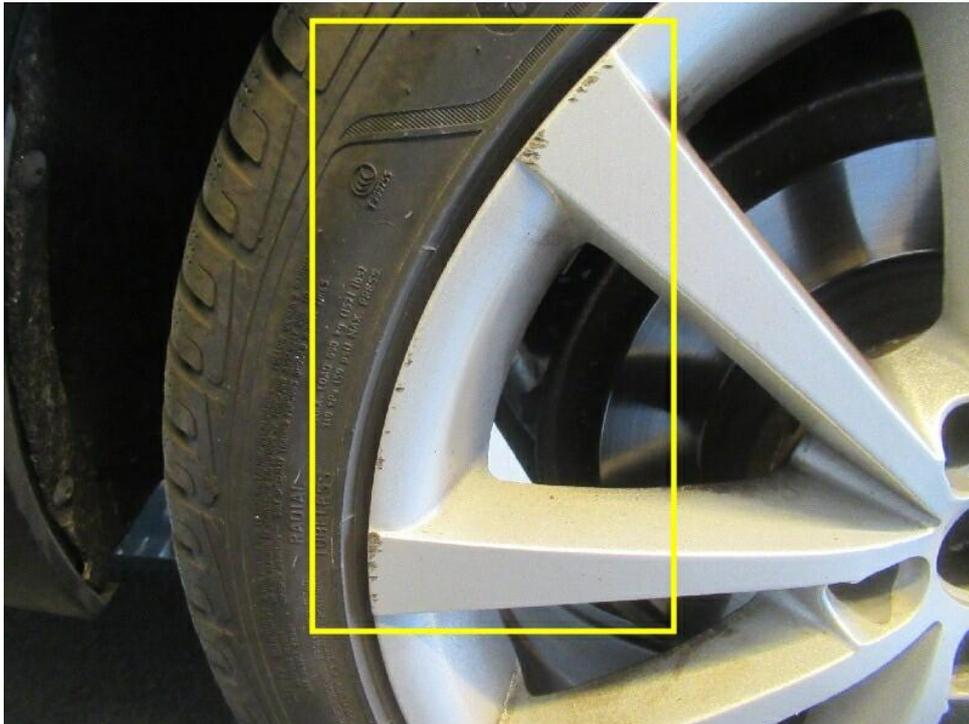
Bild 27 : Felge hinten rechts Lackierung, zerkratzt, smart repair
