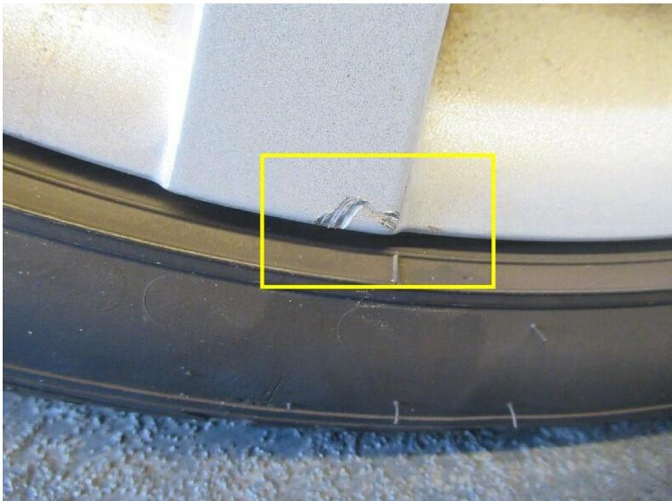
Bild 28 : Felge hinten links Lackierung, zerkratzt, smart repair
