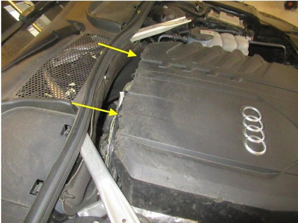
Bild 19 : Motorhaubendämmung, Motorabdeckung und Hitzeschutzverkleidung Unterboden mit Marderverbiss
