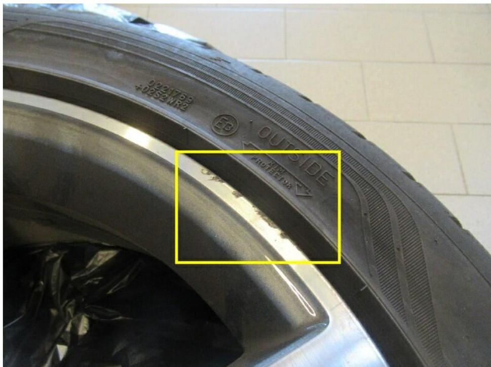
Bild 22 : Glanzgedrehte Felge Sommerradsatz vorne links verkratzt mit Materialabtrag
