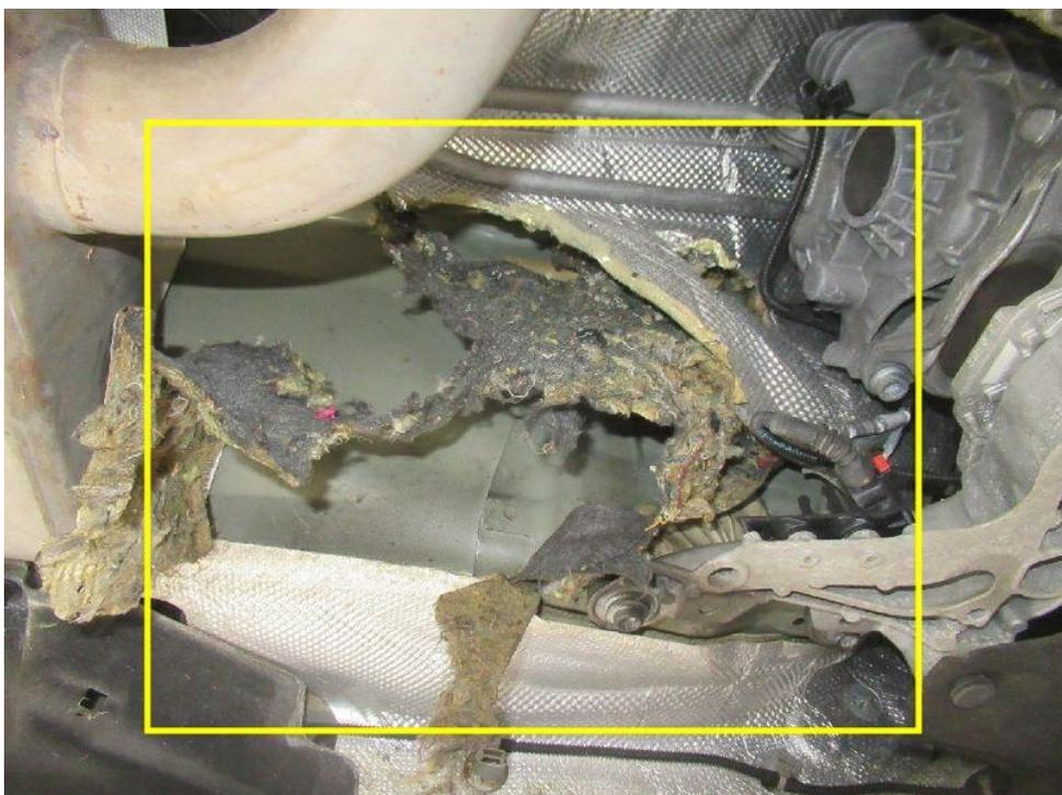
Bild 20 : Motorhaubendämmung, Motorabdeckung und Hitzeschutzverkleidung Unterboden mit Marderverbiss
