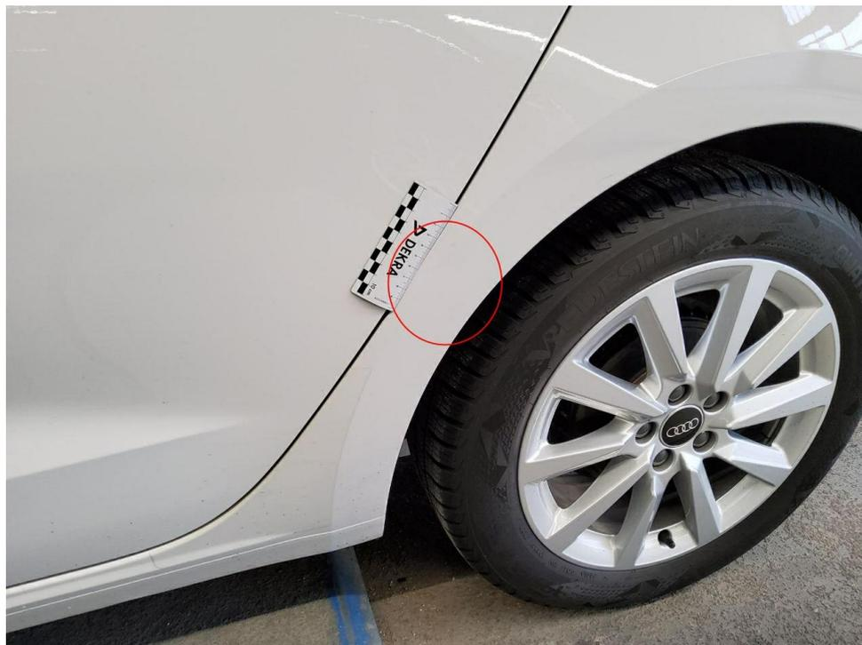
Bild 13 : Seitenteil hinten links, eingedellt, drücken
