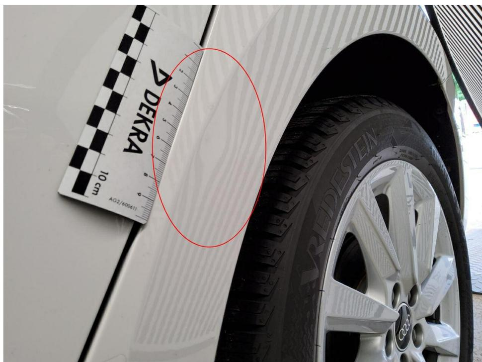
Bild 14 : Seitenteil hinten links, eingedellt, drücken
