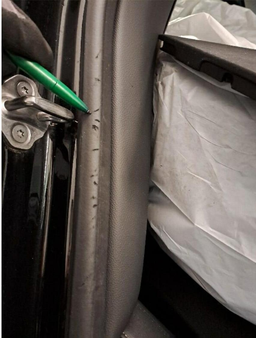
Bild 26 : Kantenschutz hinten rechts eingerissen
