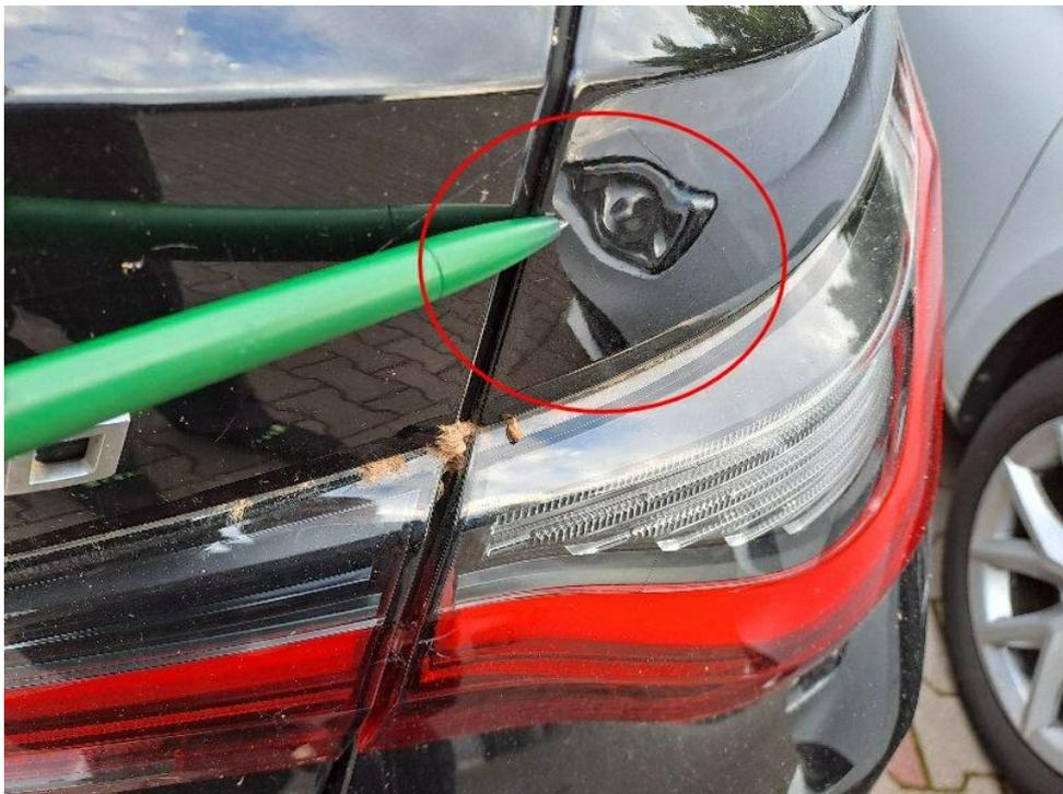
Bild 38 : Seitenwand hinten rechts Delle
