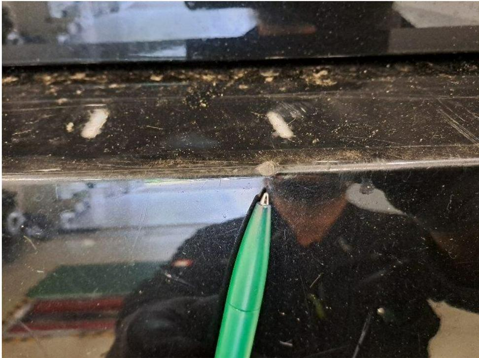
Bild 27 : Stoßfänger hinten Kratzer + Verformungen
