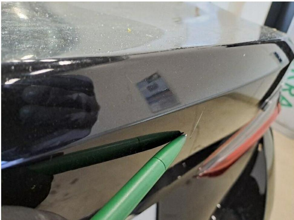
Bild 20 : Heckklappe Kratzer + Delle
