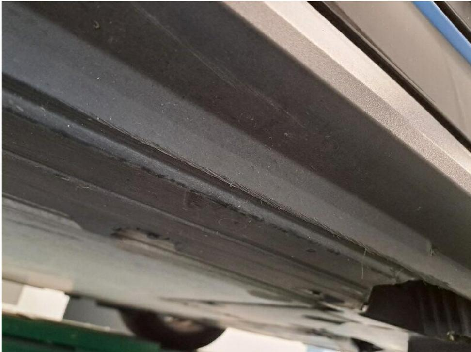
Bild 35 : Schwellerblende links Kratzer
