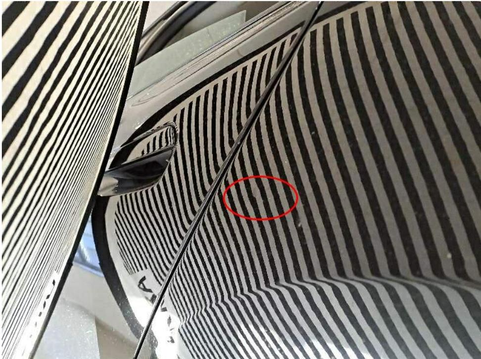
Bild 29 : Seitenwand hinten links Delle
