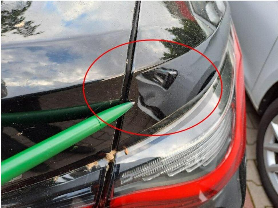
Bild 37 : Seitenwand hinten rechts Delle
