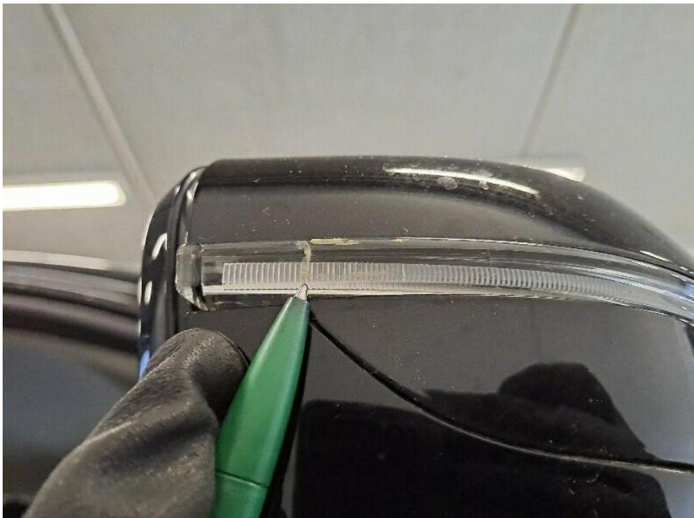
Bild 24 : Spiegelblinker rechts Kratzer
