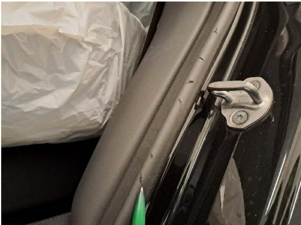
Bild 30 : Kantenschutz hinten links eingerissen
