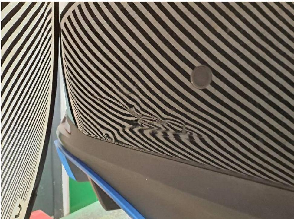
Bild 28 : Stoßfänger hinten Kratzer + Verformungen
