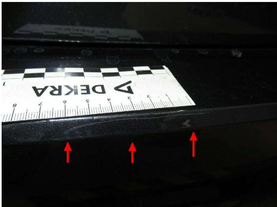
Bild 24 : Stoßfänger hinten Lackierung, zerkratzt, polieren
