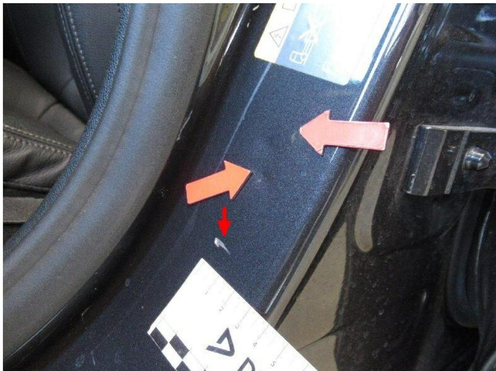
Bild 19 : Einstieg vorne links zerkratzt und eingedellt
