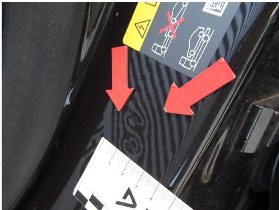
Bild 20 : Einstieg vorne links zerkratzt und eingedellt
