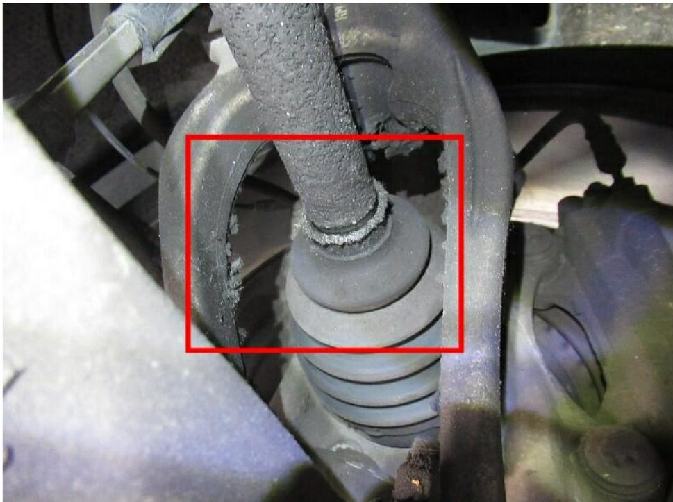
Bild 26 : T- Antriebswellenmanschette vorne rechts außen Fettverlust
