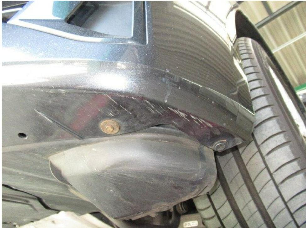
Bild 21 : Stoßfänger vorne zerkratzt und eingedellt
