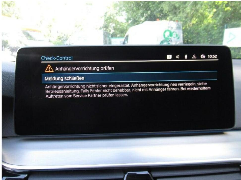
Bild 17 : Anhängerkupplung Fehlermeldung
