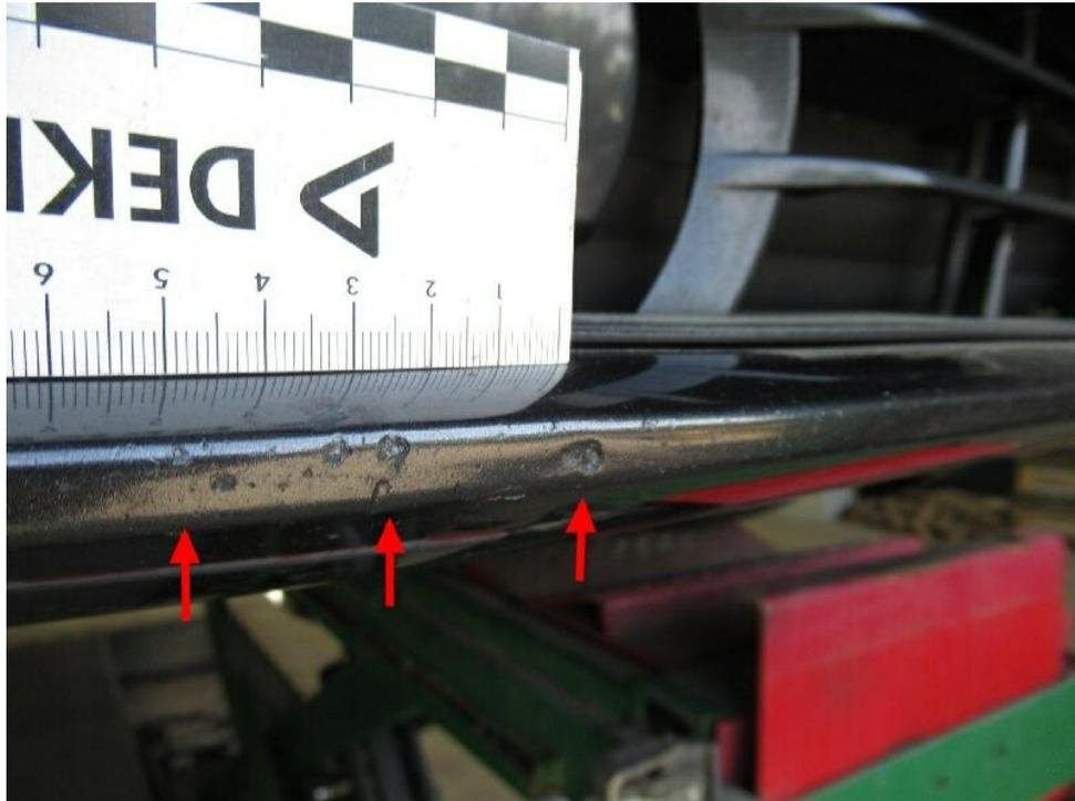
Bild 23 : Stoßfänger vorne zerkratzt und eingedellt
