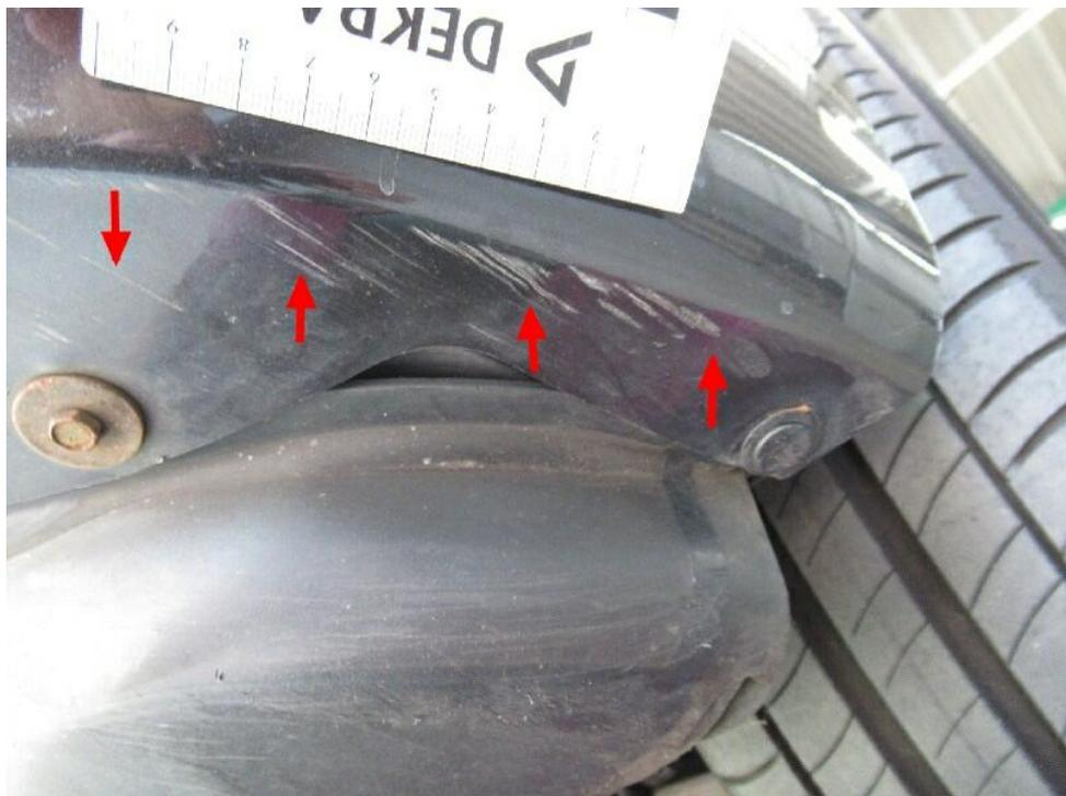
Bild 22 : Stoßfänger vorne zerkratzt
