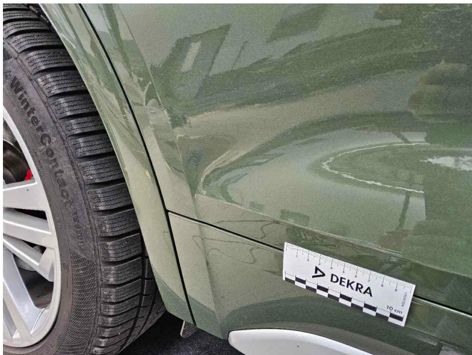
Bild 22 : Seitenwand und Tür hinten rechts, teilweise eingedellt und Lackierung verschrammt
