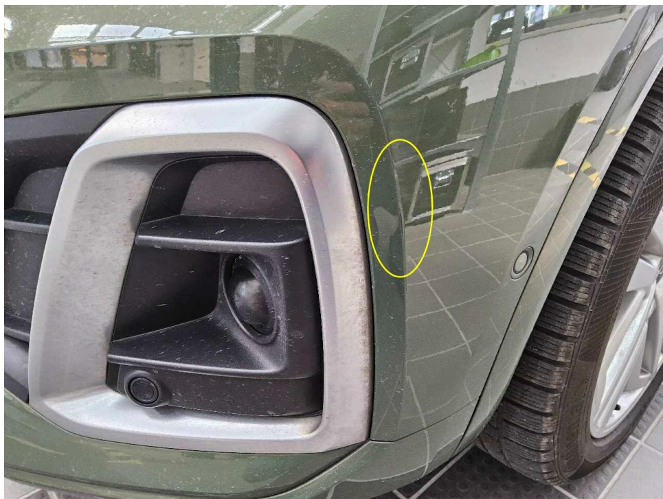
Bild 16 : Stoßfänger vorne Lackierung, zerkratzt
