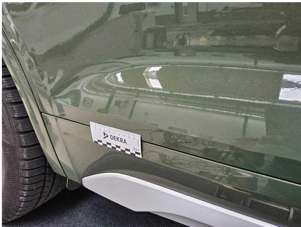
Bild 21 : Seitenwand und Tür hinten rechts, teilweise eingedellt und Lackierung verschrammt
