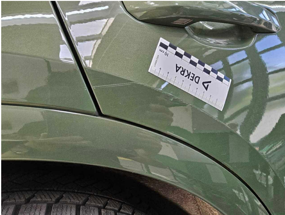
Bild 19 : Seitenwand und Tür hinten rechts, teilweise eingedellt und Lackierung verschrammt
