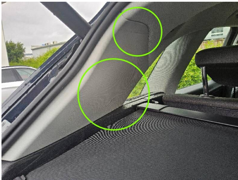
Bild 25 : Blende D-Säule hinten links verschrammt, erneuern
