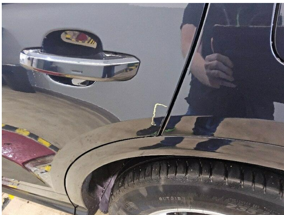
Bild 23 : Tür hinten links Türkante, Lackabplatzer, Gebrauchsspur
