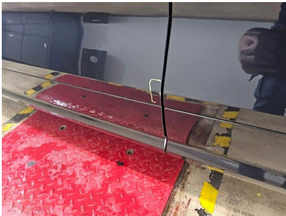
Bild 22 : Tür hinten links Türkante, Lackabplatzer, Gebrauchsspur
