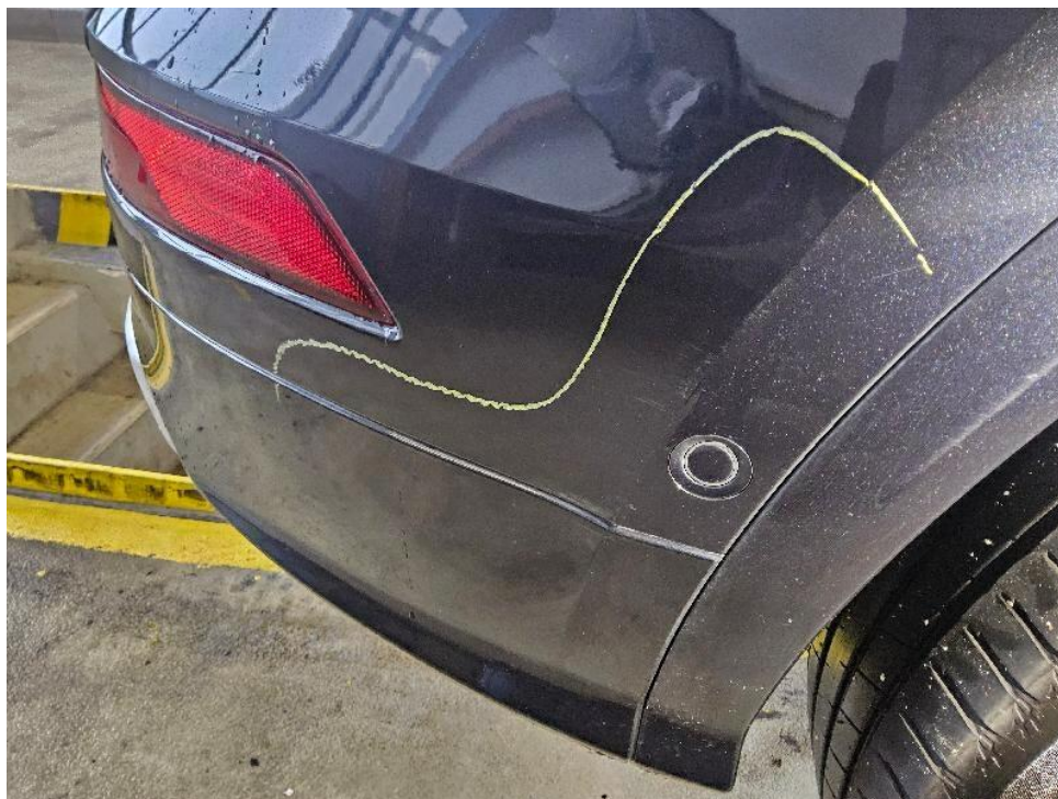
Bild 16 : Stoßfänger hinten Lackierung, zerkratzt, polieren
