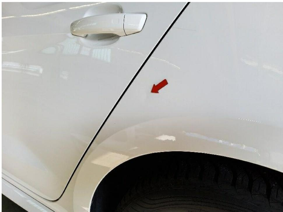
Bild 14 : Seitenwand hinten links größere "weiche" Delle
