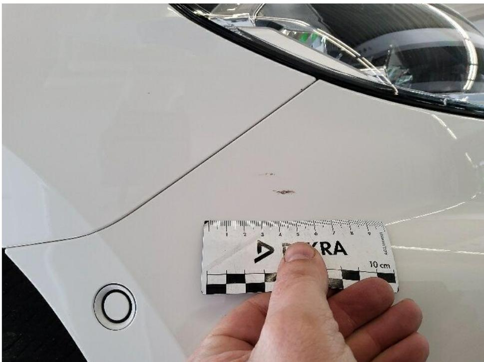
Bild 18 : Frontstoßfängerverkleidung rechtsseitig verschrammt bis zur Grundierung
