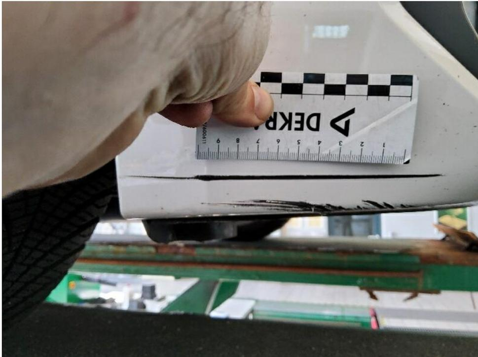
Bild 17 : Frontstoßfängerverkleidung rechtsseitig verschrammt bis zur Grundierung
