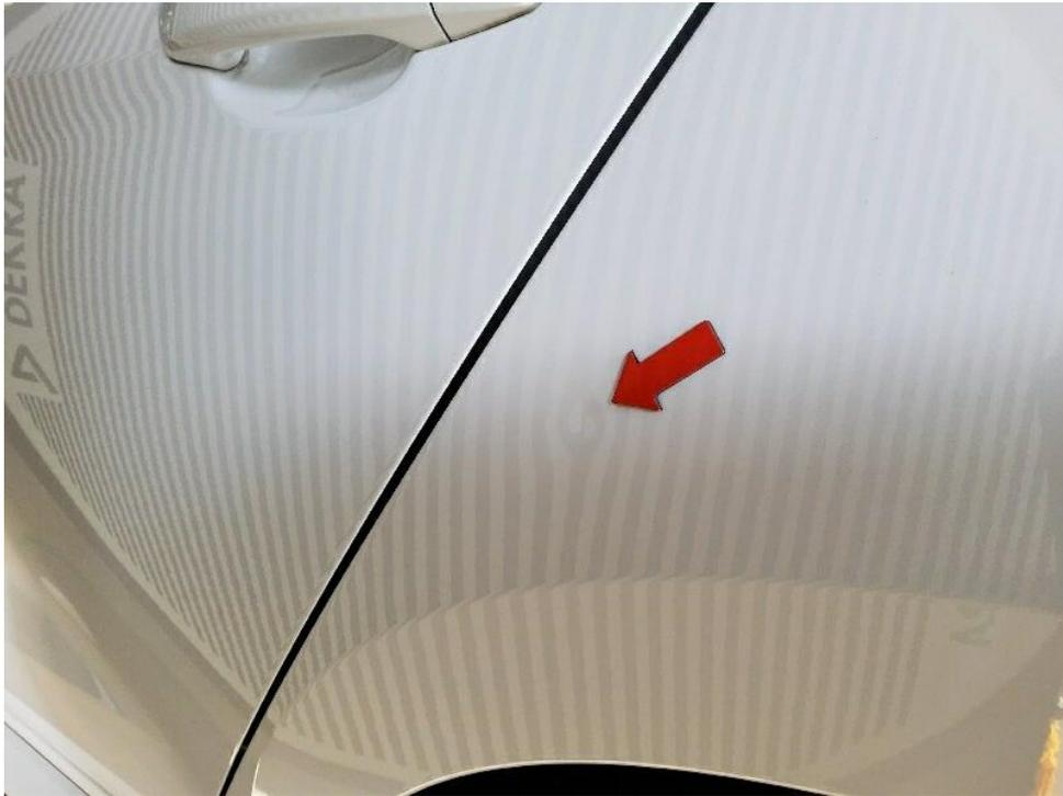
Bild 15 : Seitenwand hinten links größere "weiche" Delle
