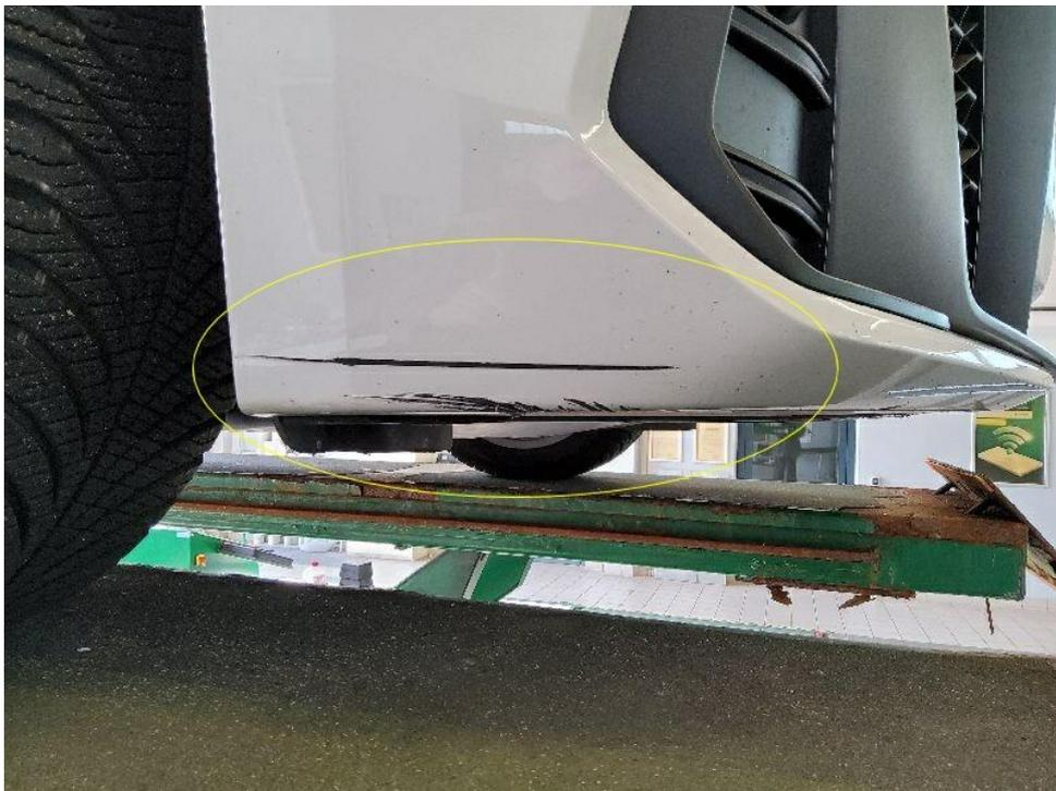
Bild 16 : Frontstoßfängerverkleidung rechtsseitig verschrammt bis zur Grundierung
