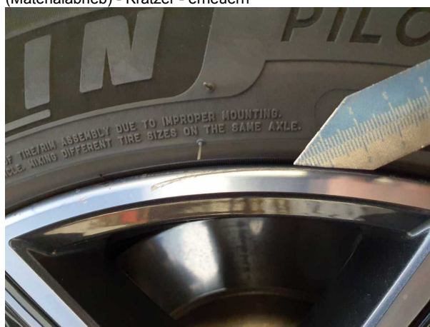
Beschädigung #3: Rad/Reifen: Leichtmetallfelge vorn rechts (Materialabrieb) - Kratzer - erneuern
