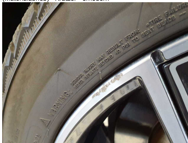
Beschädigung #2: Rad/Reifen: Leichtmetallfelge vorn links (Materialabrieb) - Kratzer - erneuern
