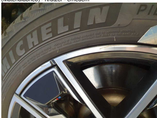
Beschädigung #3: Rad/Reifen: Leichtmetallfelge vorn rechts (Materialabrieb) - Kratzer - erneuern
