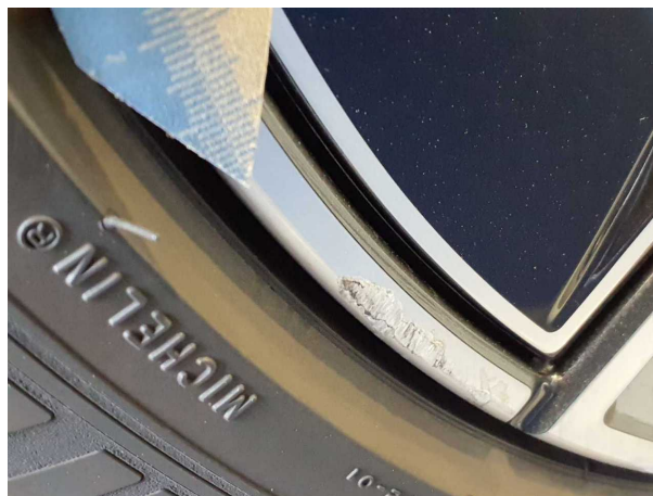
Beschädigung #1: Rad/Reifen: Leichtmetallfelge hinten rechts (Materialabrieb) - Kratzer - erneuern
