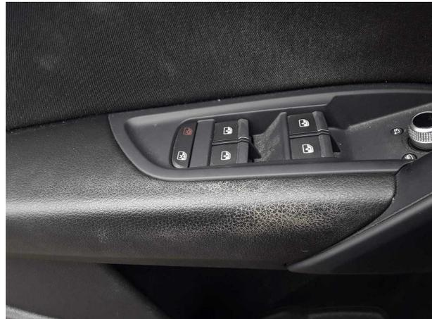
**Beschädigung #1:** Verkleidungen/Abdeckungen: Türverkleidung vorn links - Abrieb - Smart Repair
