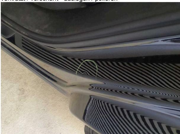
**Beschädigung #2:** Seitenwand links: Einstieg - Delle(n) - sanft instandsetzen
