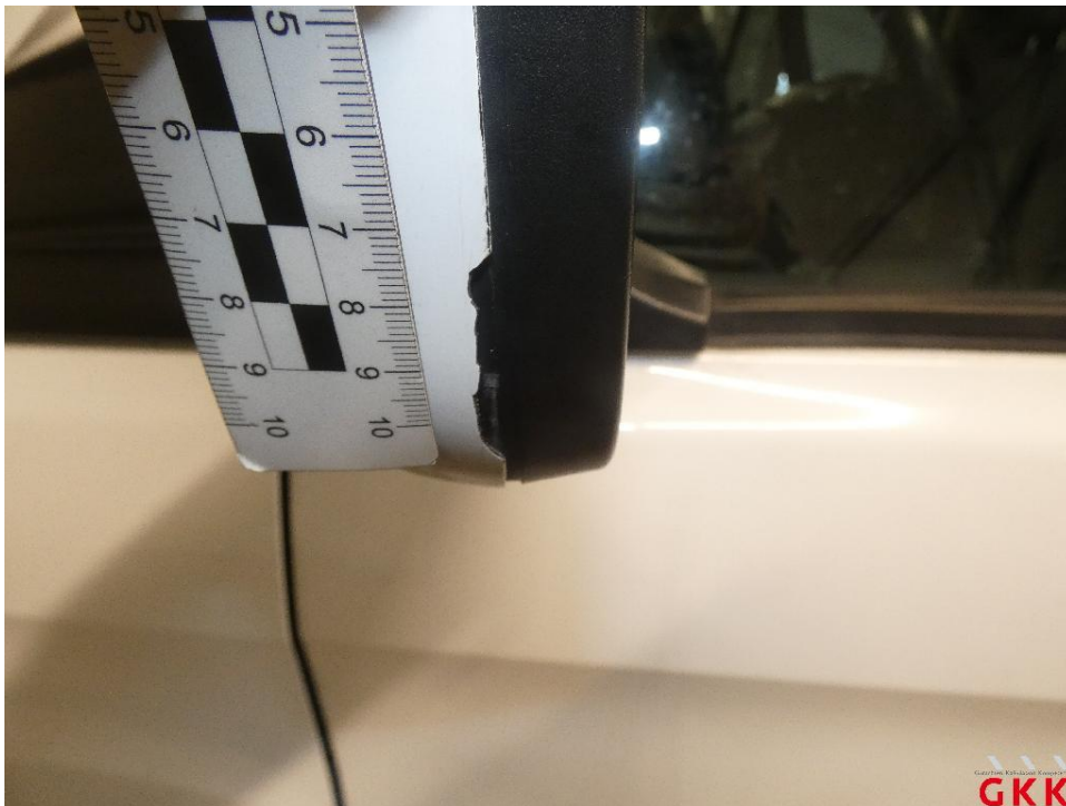
Bild 26 Spiegelgehäuse links, Kappe -lackiert-, beschädigt, ersetzen
