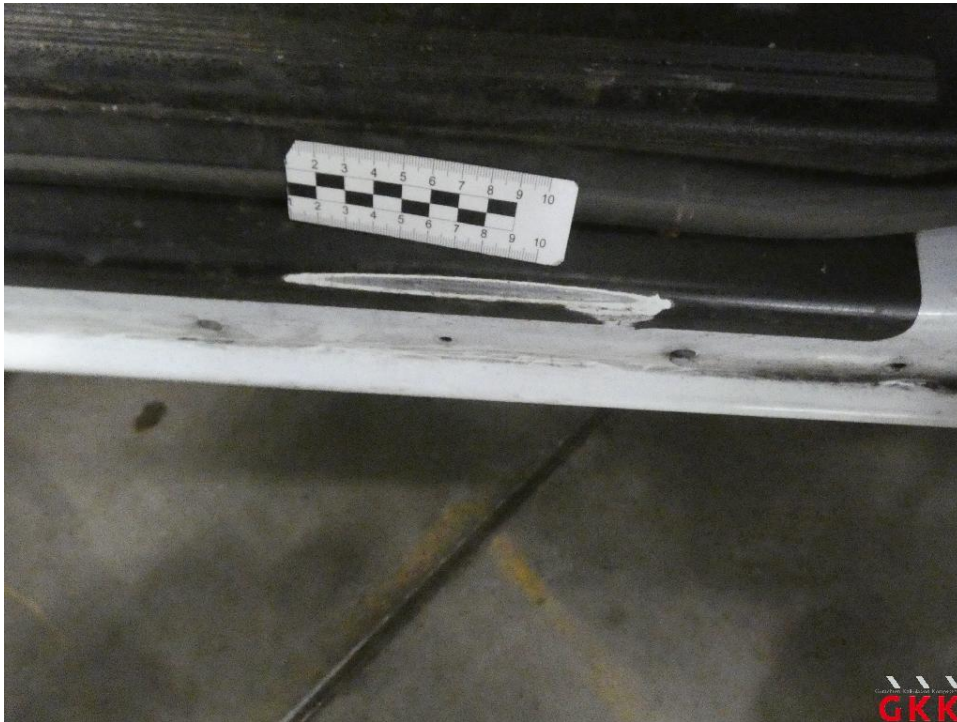
Bild 29 Tür vorne links, Einstieg, verkratzt, lackieren
