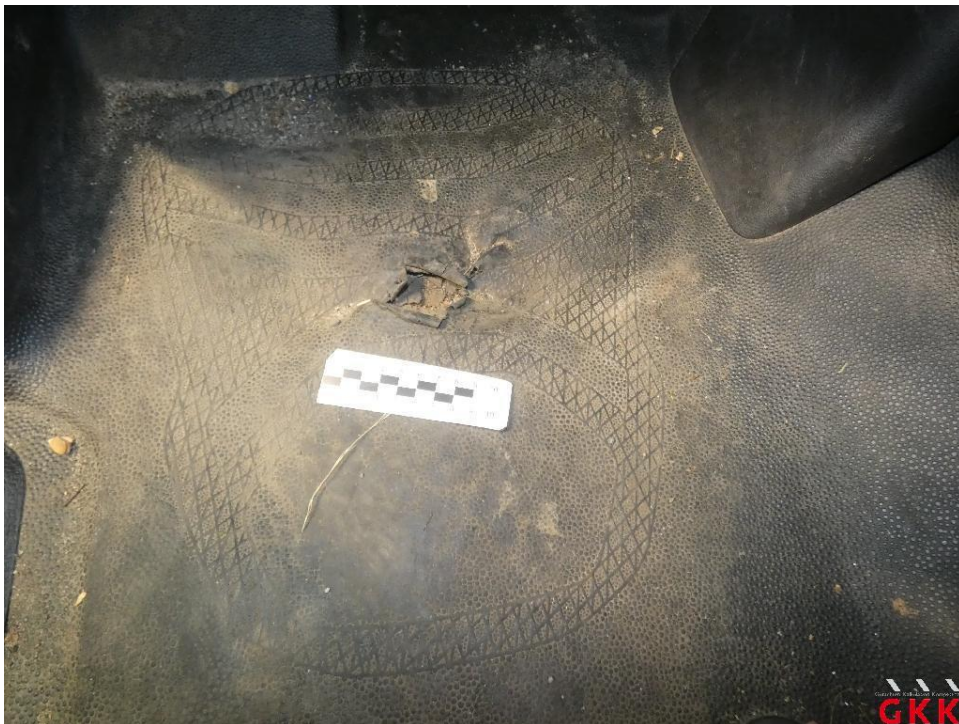
Bild 34 Fahrerhaus, Bodenbelag, beschädigt, ersetzen
