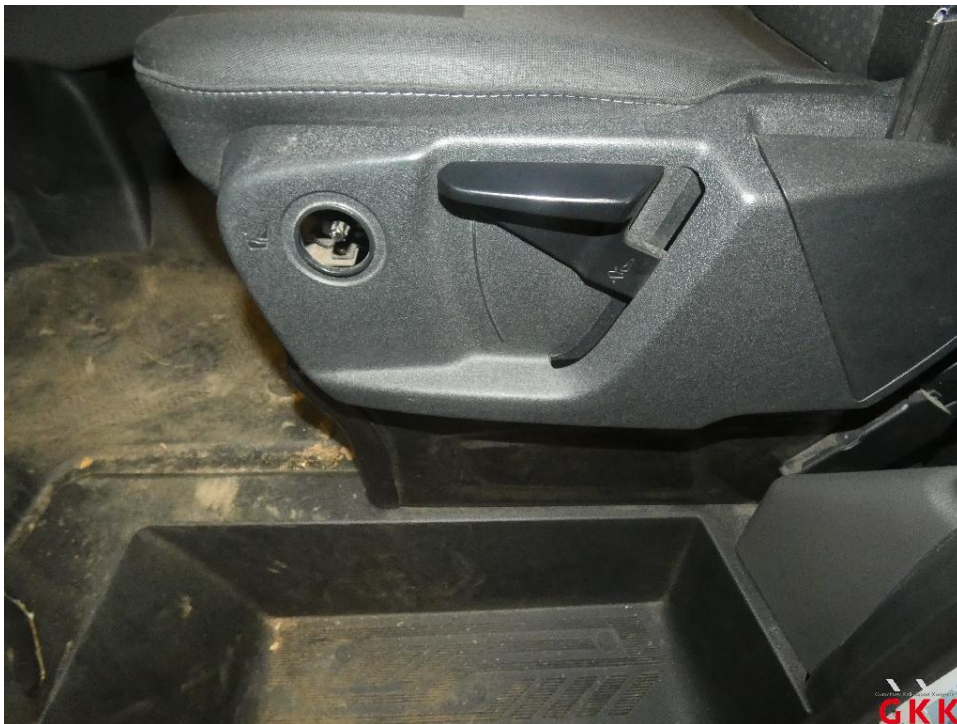
Bild 32 Sitz vorne links, Sitzverstellung, fehlt, ersetzen
