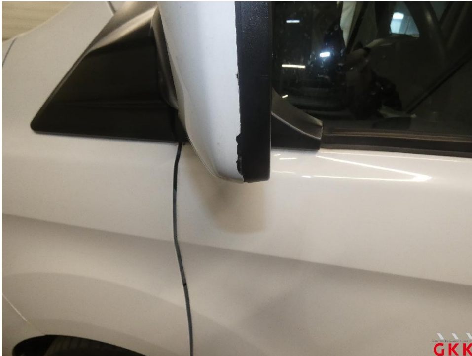
Bild 25 Spiegelgehäuse links, Kappe -lackiert-, beschädigt, ersetzen
