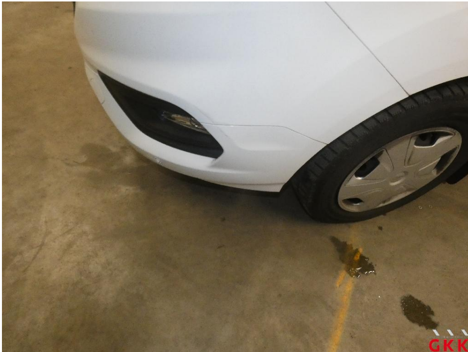
Bild 23 Stoßfänger vorne, Verkleidung unterhalb -lackiert-, verkratzt, Spotlackieren
