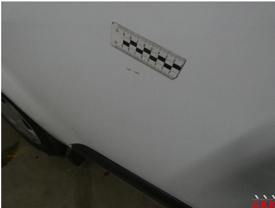
Bild 28 Tür vorne links, verkratzt, lackieren
