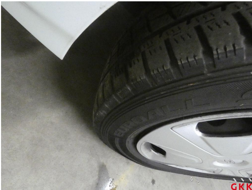
Bild 22 Reifen, vorn links und rechts, einseitig abgefahren, ersetzen
