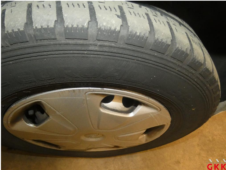
Bild 21 Reifen, vorn links und rechts, einseitig abgefahren, ersetzen
