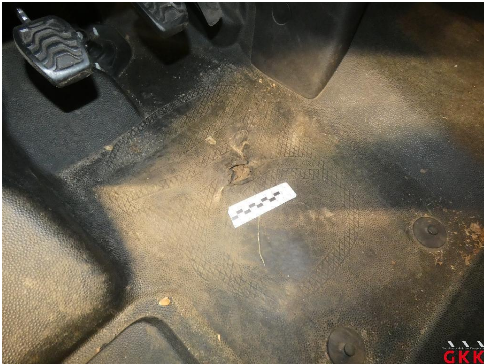
Bild 33 Fahrerhaus, Bodenbelag, beschädigt, ersetzen
