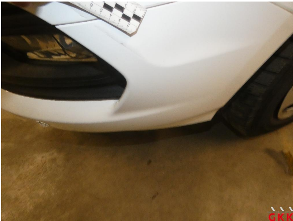
Bild 24 Stoßfänger vorne, Verkleidung unterhalb -lackiert-, verkratzt, Spotlackieren
