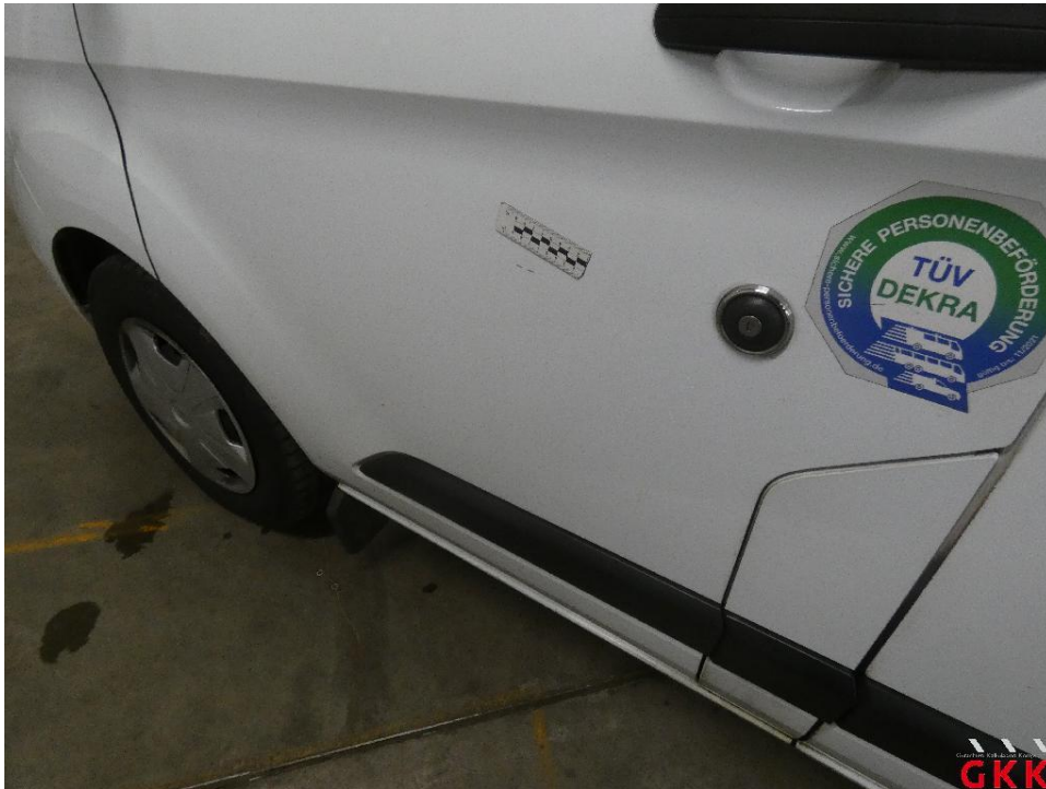
Bild 27 Tür vorne links, verkratzt, lackieren
