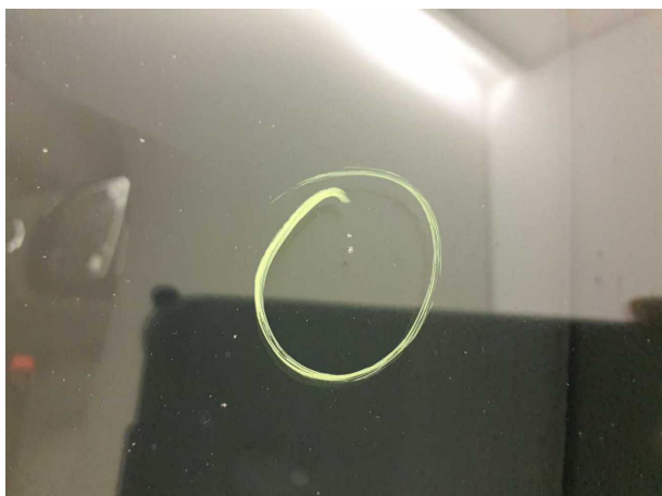
Beschädigung #6: Verglasung: Frontscheibe - Steinschlag - erneuern
