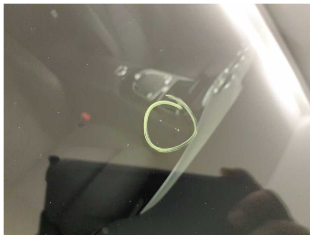
Beschädigung #6: Verglasung: Frontscheibe - Steinschlag - erneuern
