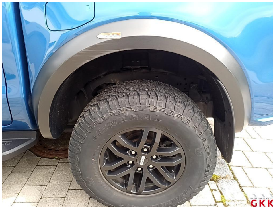
Bild 14 Seitenwand links, Blende -unlackiert-, verkratzt, ersetzen
