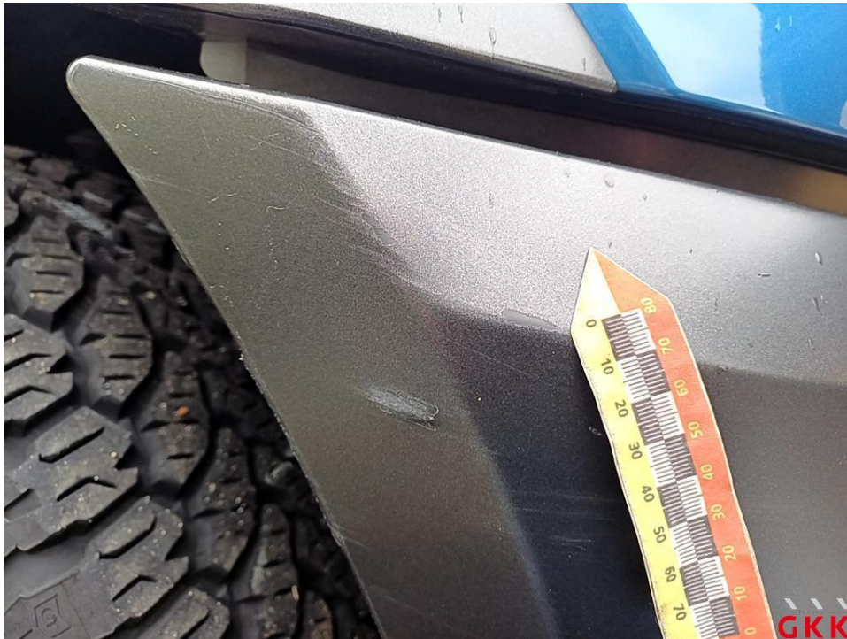
Bild 19 Stoßfänger vorne, Verkleidung -unlackiert-, beschädigt, ersetzen
