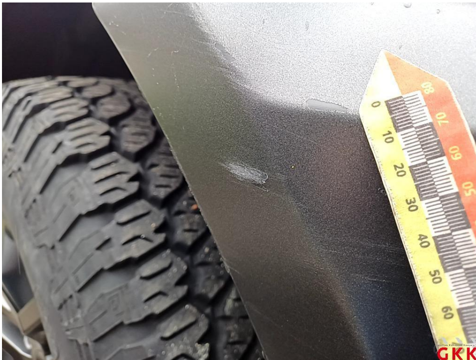
Bild 20 Stoßfänger vorne, Verkleidung -unlackiert-, beschädigt, ersetzen
