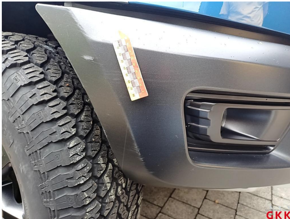
Bild 18 Stoßfänger vorne, Verkleidung -unlackiert-, beschädigt, ersetzen
