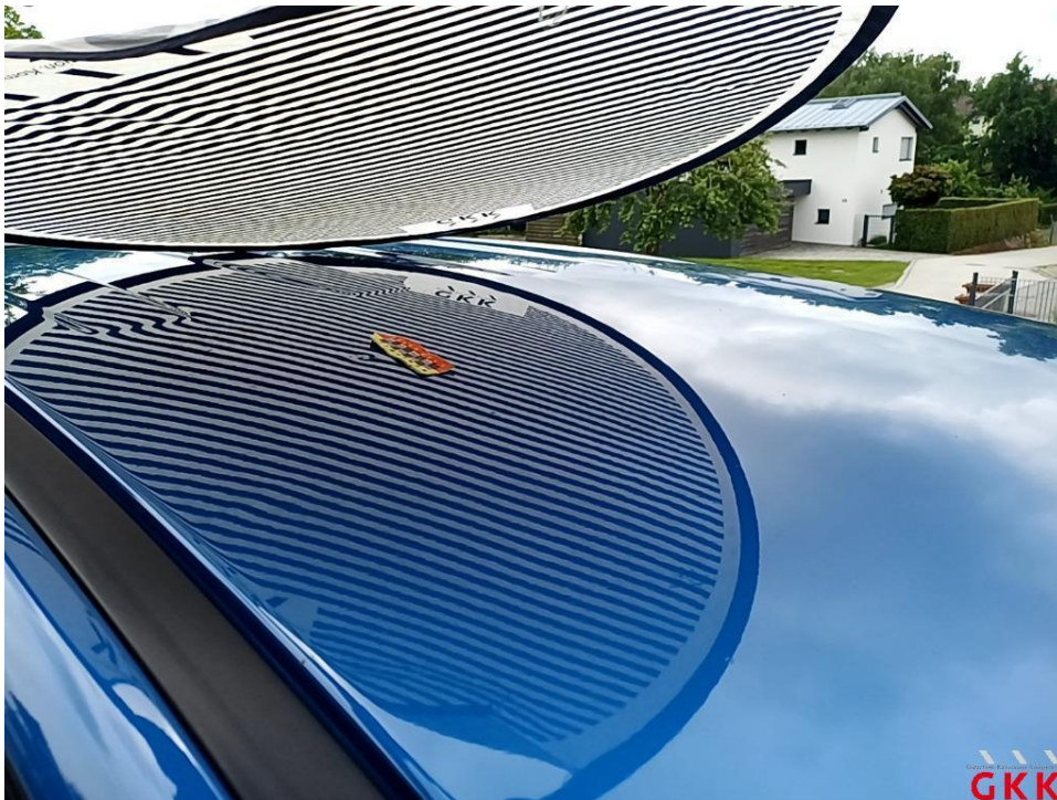
Bild 16 Dach, beschädigt, lackieren
