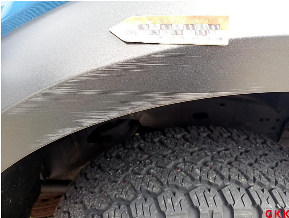
Bild 15 Seitenwand links, Blende -unlackiert-, verkratzt, ersetzen
