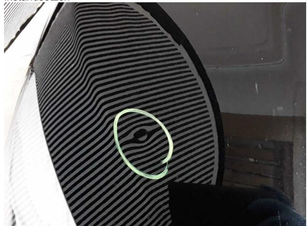
**Beschädigung #5:** Motorhaube: Motorhaube - Delle(n) - sanft instandsetzen
