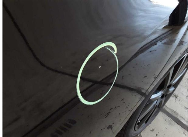
**Beschädigung #7:** Tür hinten links: Tür - Delle / Lackschade... instandsetzen und lackieren
