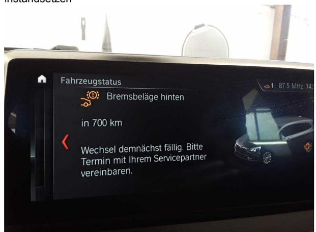
**Beschädigung #6:** Bremsanlage: Bremsscheiben und Beläge hinten (Laut Anzeige) - verschlissen - erneuern
