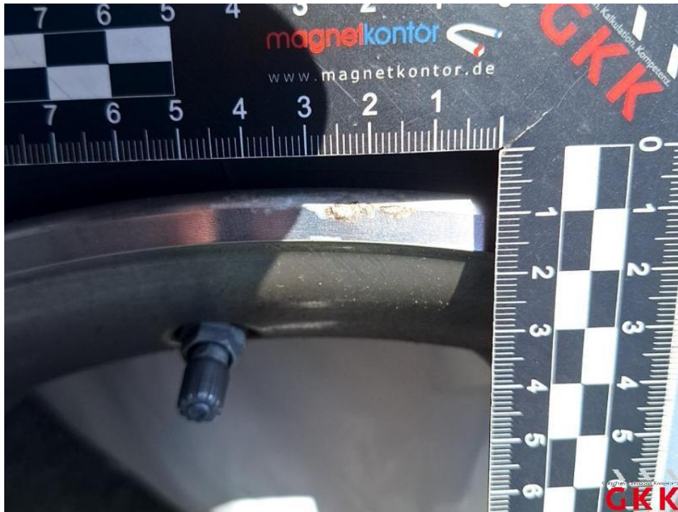
Bild 29. LM-Rad, 1 x beiliegend, Materialabtrag, ersetzen
