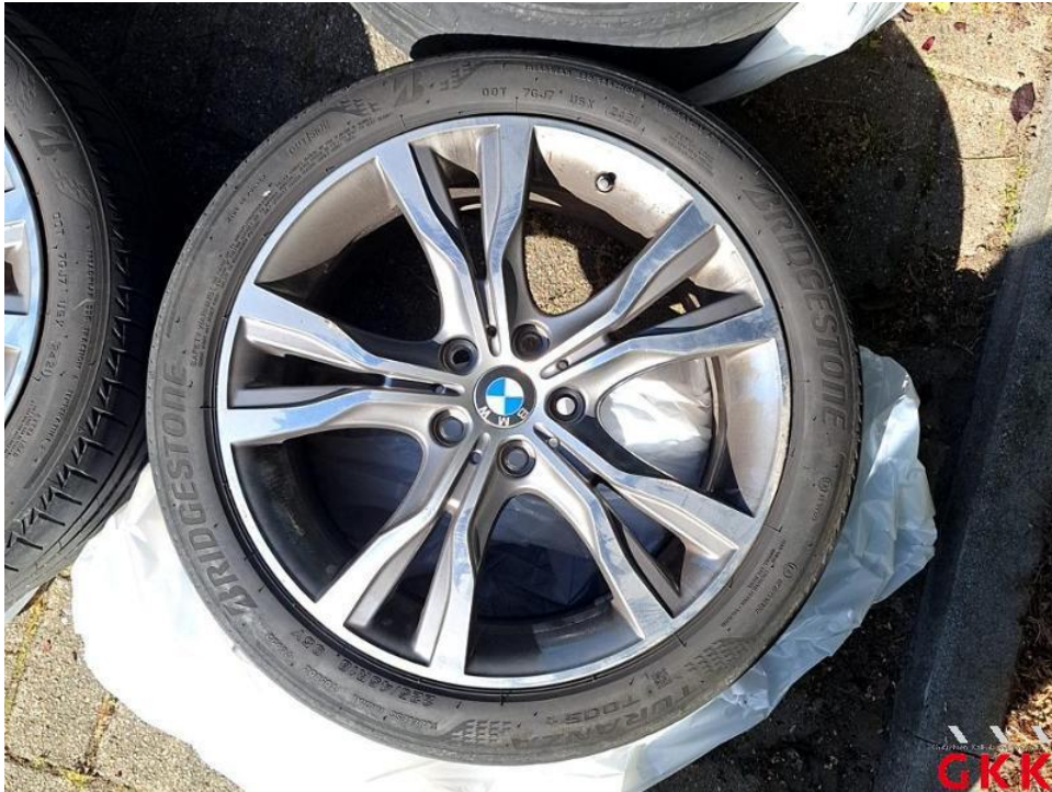
Bild 25. LM-Rad, 1 x beiliegend, verkratzt, ersetzen
