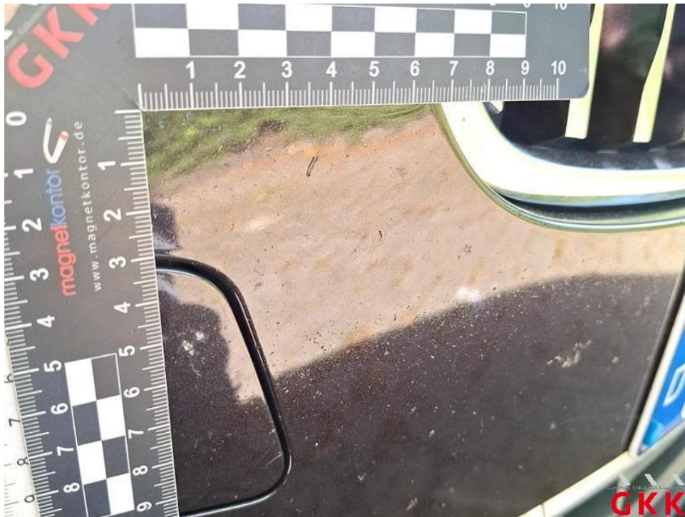
Bild 51. Stoßfänger vorne, Verkleidung -lackiert-, verkratzt, lackieren
