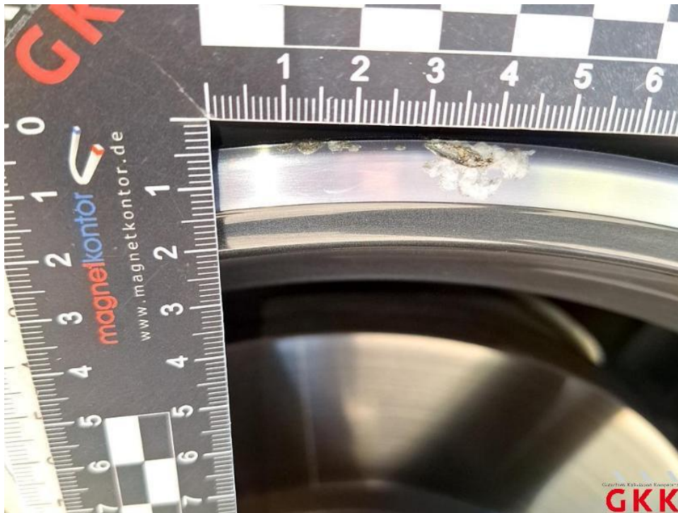
Bild 18. LM-Rad, vorne rechts, Materialabtrag, ersetzen
