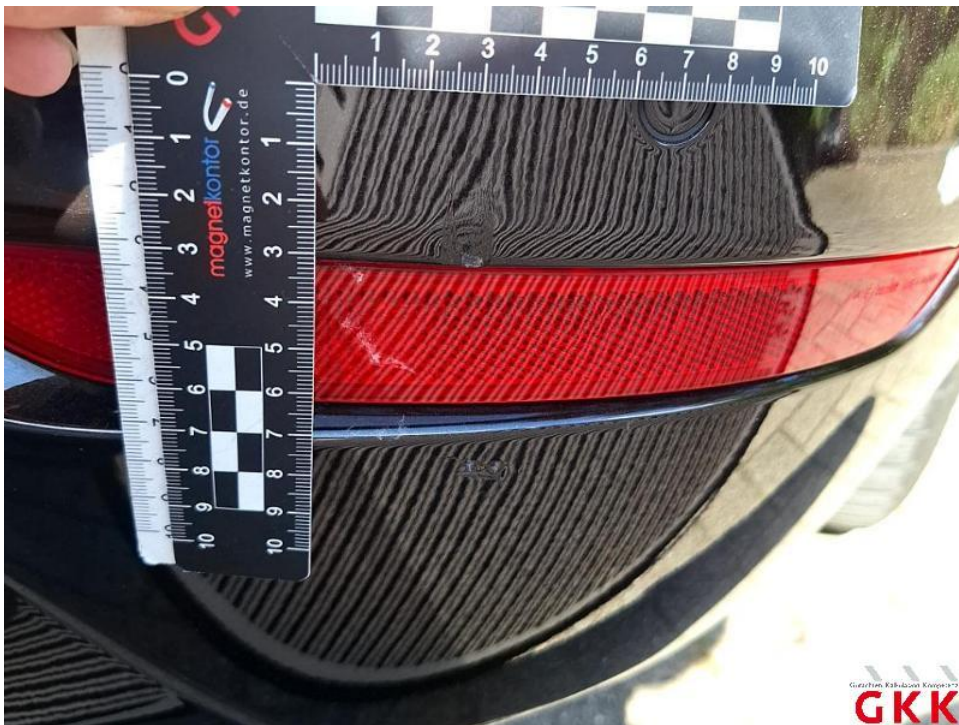
Bild 40. Stoßfänger hinten, Verkleidung -lackiert-, beschädigt, instand setzen - lackieren
