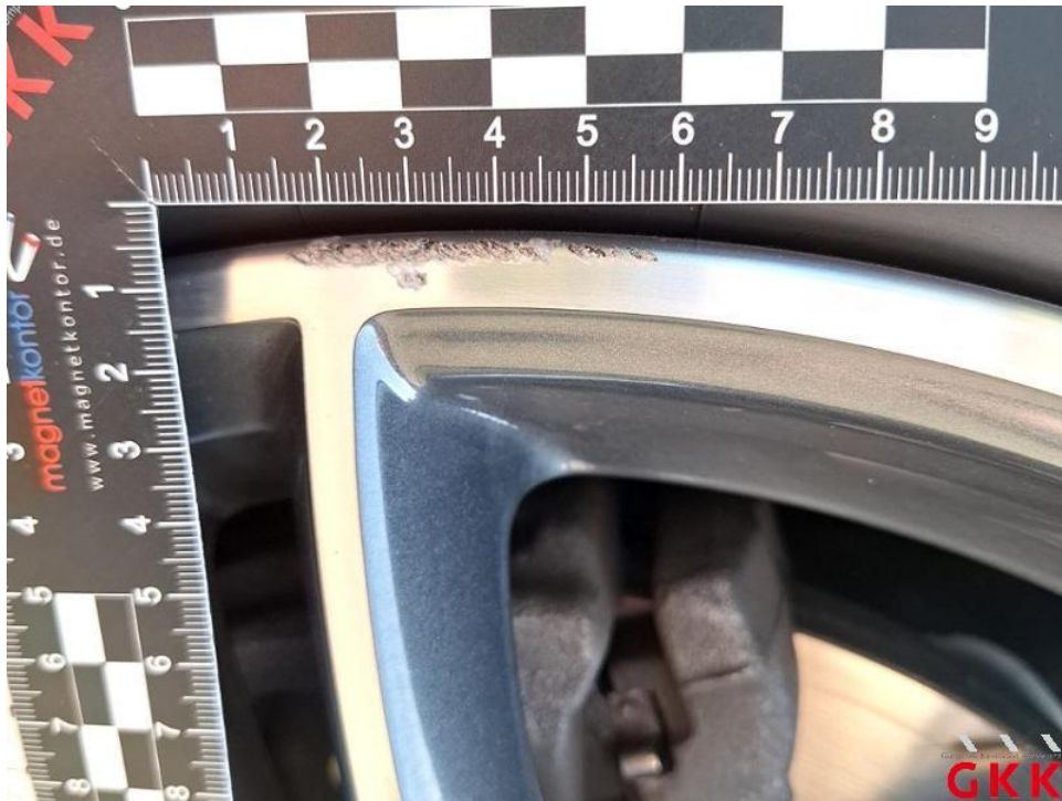
Bild 21. LM-Rad, vorne links, verkratzt, ersetzen
