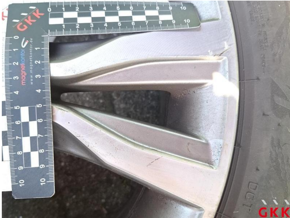
Bild 33. LM-Rad, 1 x beiliegend, verkratzt, ersetzen
