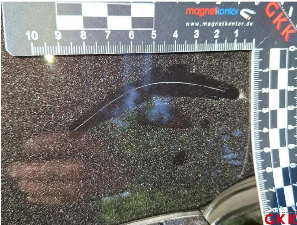
Bild 37. Tür hinten rechts, verkratzt, lackieren
