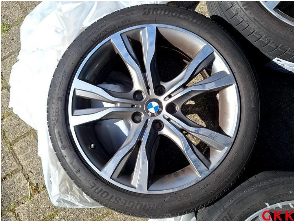
Bild 28. LM-Rad, 1 x beiliegend, Materialabtrag, ersetzen
