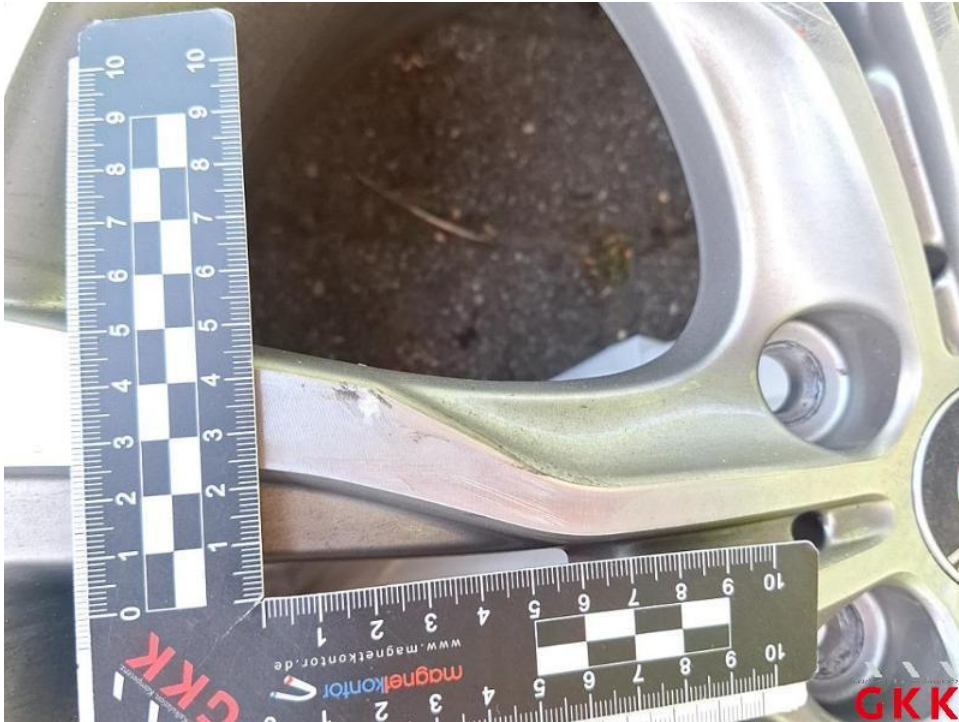
Bild 27. LM-Rad, 1 x beiliegend, verkratzt, ersetzen
