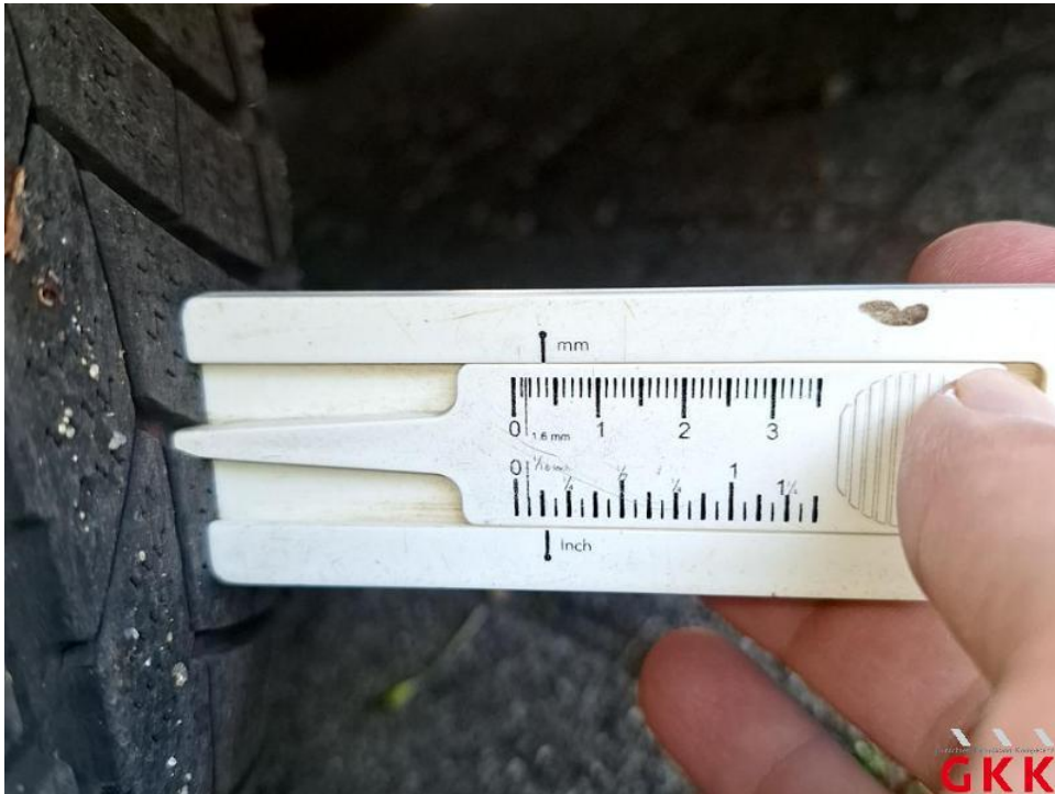
Bild 14. Reifen, vorne links, Untermaß, ersetzen
