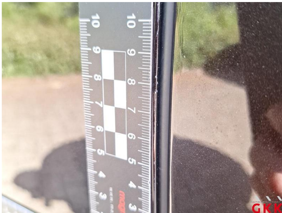
Bild 43. Tür vorne links, Kante, verkratzt, auslegen, schleifen, polieren
