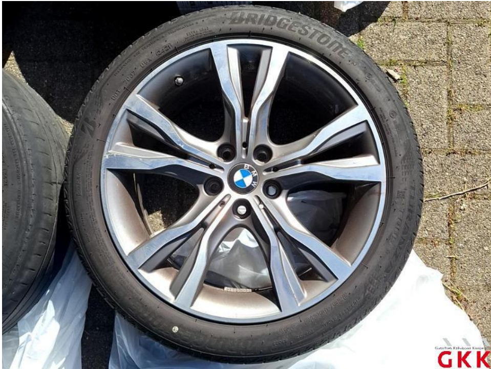
Bild 31. LM-Rad, 1 x beiliegend, verkratzt, ersetzen
