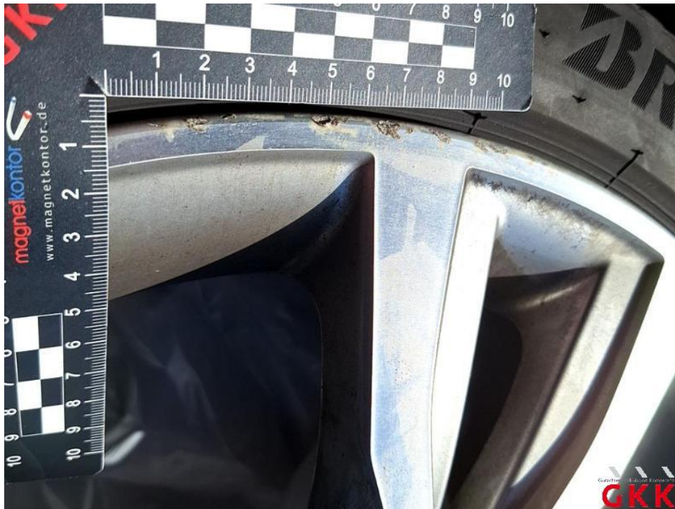
Bild 35. LM-Rad, 1 x beiliegend, verkratzt, ersetzen
