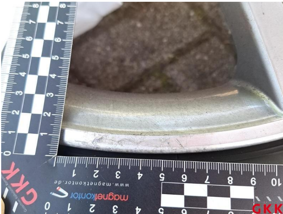
Bild 32. LM-Rad, 1 x beiliegend, verkratzt, ersetzen
