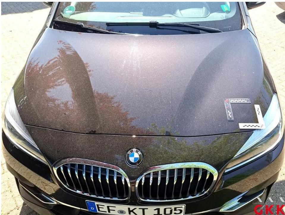
Bild 46. Motorhaube, beschädigt, instand setzen - lackieren
