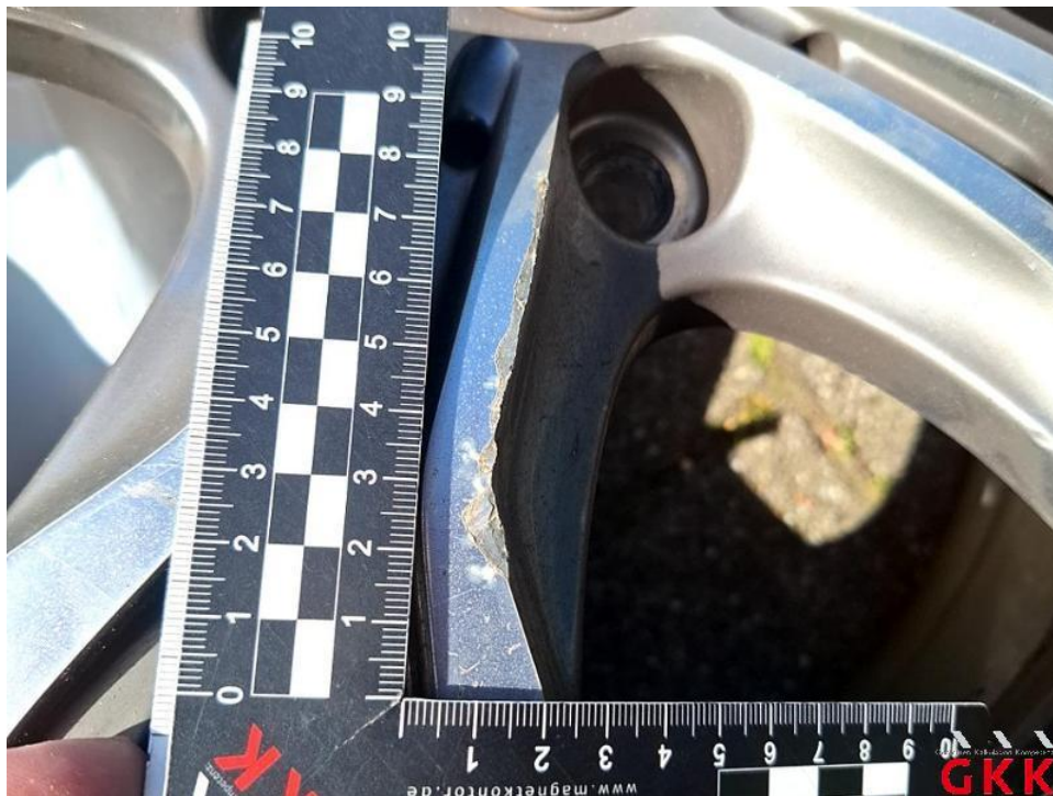
Bild 30. LM-Rad, 1 x beiliegend, Materialabtrag, ersetzen
