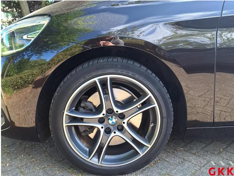
Bild 13. Reifen, vorne links, Untermaß, ersetzen
