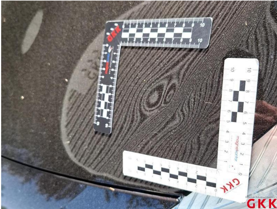
Bild 47. Motorhaube, beschädigt, instand setzen - lackieren
