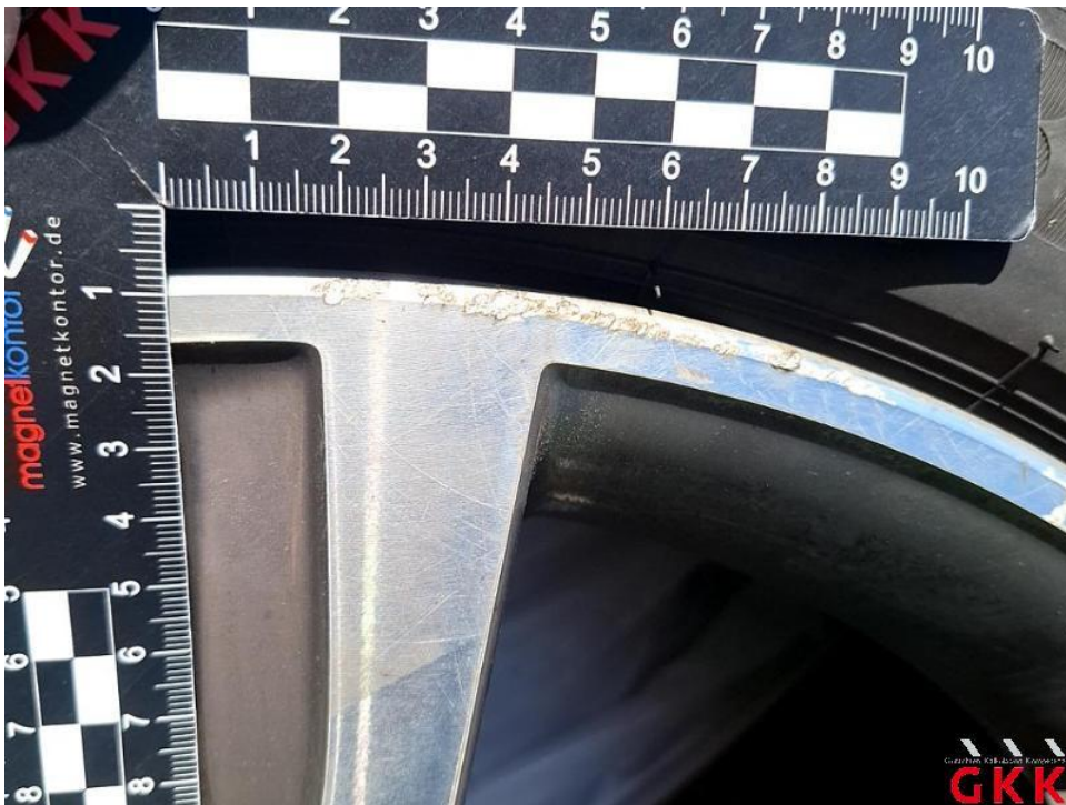
Bild 26. LM-Rad, 1 x beiliegend, verkratzt, ersetzen
