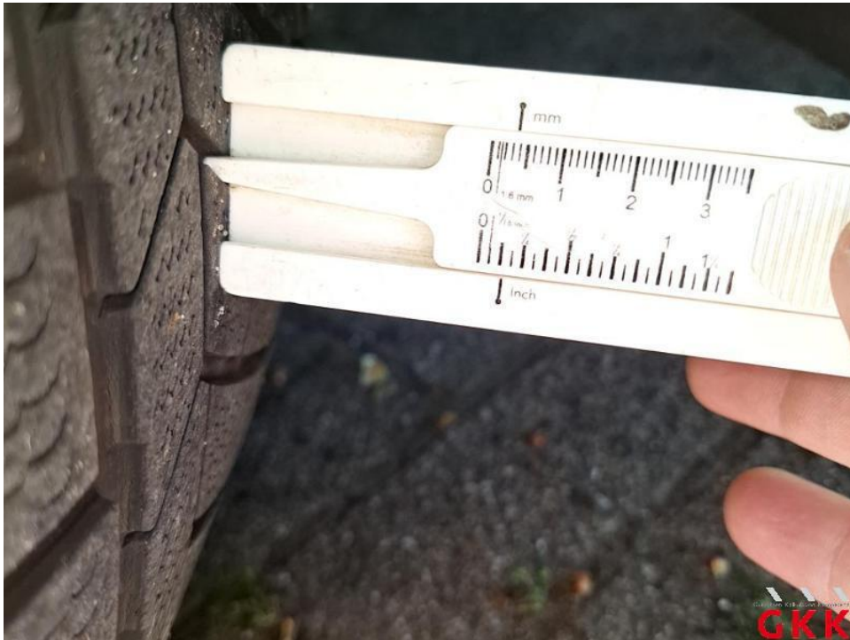
Bild 16. Reifen, vorne rechts, Untermaß, ersetzen
