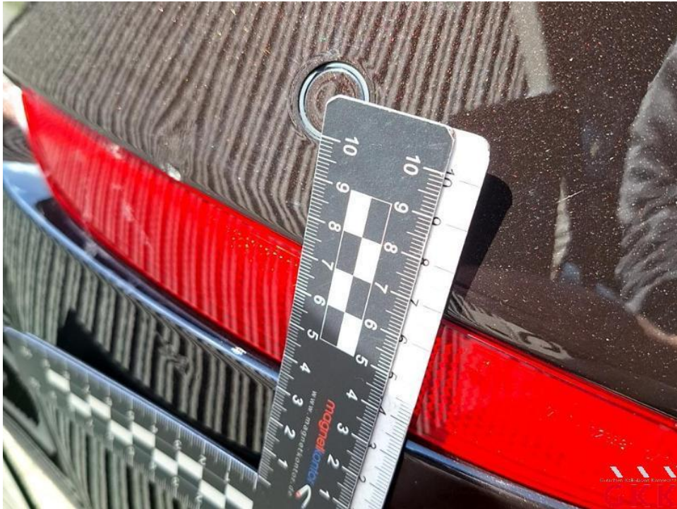
Bild 39. Stoßfänger hinten, Verkleidung -lackiert-, beschädigt, instand setzen - lackieren
