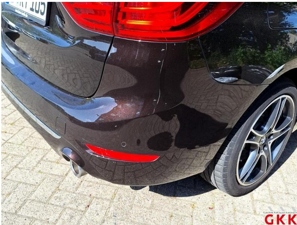
Bild 38. Stoßfänger hinten, Verkleidung -lackiert-, beschädigt, instand setzen - lackieren
