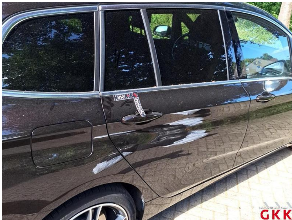
Bild 36. Tür hinten rechts, verkratzt, lackieren
