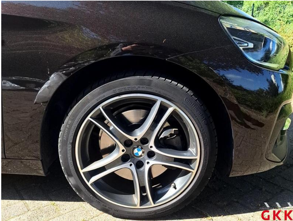
Bild 15. Reifen, vorne rechts, Untermaß, ersetzen
