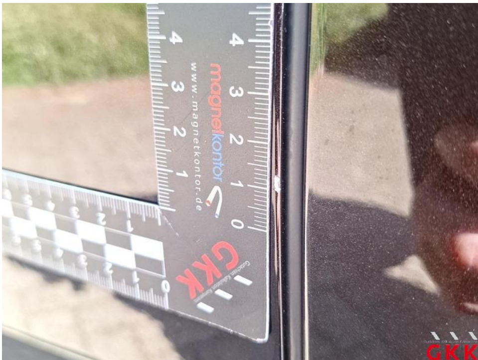
Bild 42. Tür vorne links, Kante, verkratzt, auslegen, schleifen, polieren
