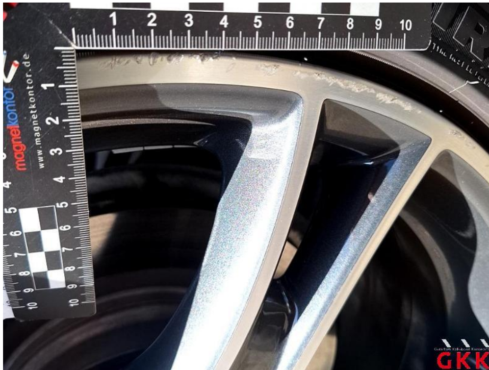
Bild 23. LM-Rad, hinten rechts, verkratzt, ersetzen
