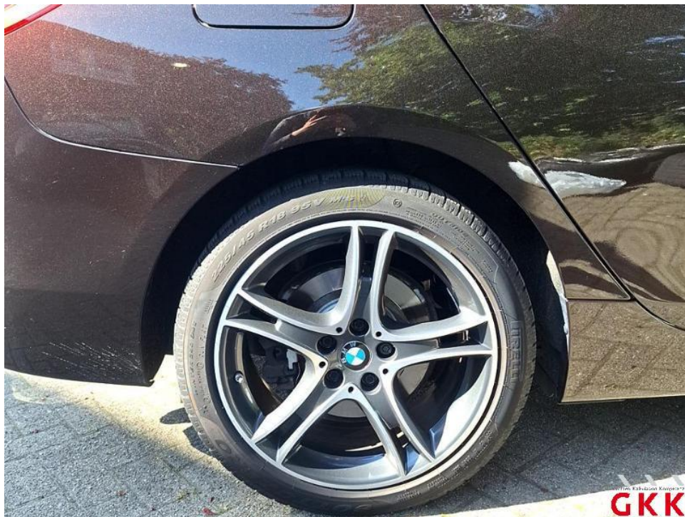
Bild 22. LM-Rad, hinten rechts, verkratzt, ersetzen
