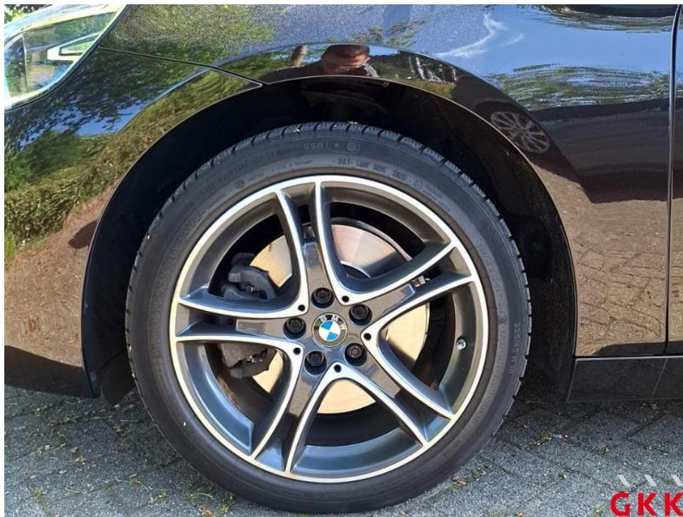
Bild 20. LM-Rad, vorne links, verkratzt, ersetzen
