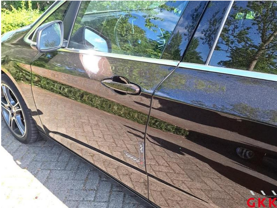
Bild 41. Tür vorne links, Kante, verkratzt, auslegen, schleifen, polieren
