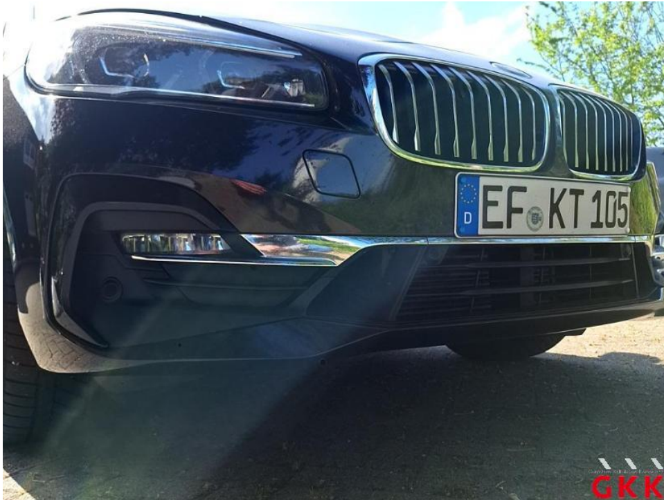
Bild 49. Stoßfänger vorne, Verkleidung -lackiert-, verkratzt, lackieren
