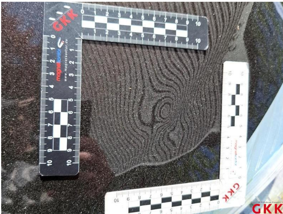
Bild 48. Motorhaube, beschädigt, instand setzen - lackieren
