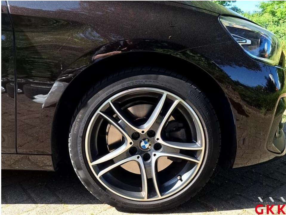
Bild 17. LM-Rad, vorne rechts, Materialabtrag, ersetzen
