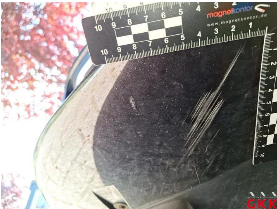
Bild 50. Stoßfänger vorne, Verkleidung -lackiert-, verkratzt, lackieren
