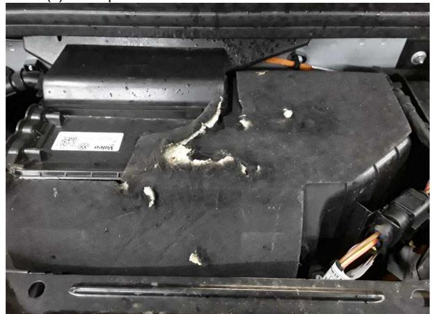
**Dommage #4:** Moteur: Capot de moteur haut / Cache - Dommage provoqué par les martres/rongeurs - Remplacer
