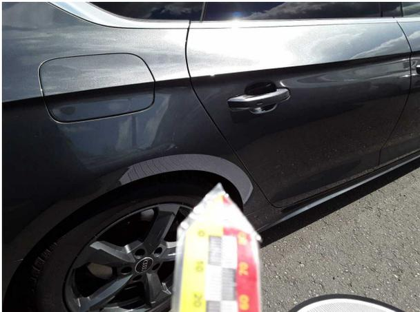
**Beschädigung #1:** Seitenwand rechts: Seitenwand - Delle(n) - sanft instandsetzen
