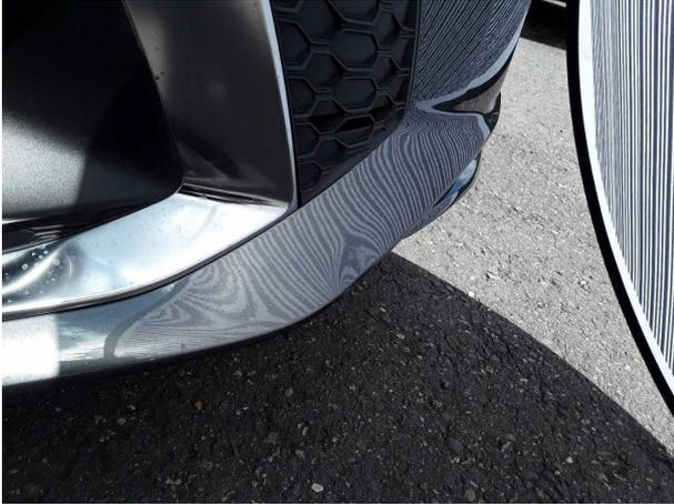
**Beschädigung #4:** Stossfänger vorn: Stossfänger vorn (Sst. gestaucht) - verformt - erneuern
