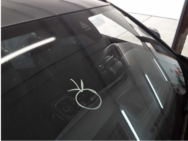
Dommage #9: Vitrage: Pare-brise (Rissbildung) - Dommage causé par des cailloux - Remplacer
