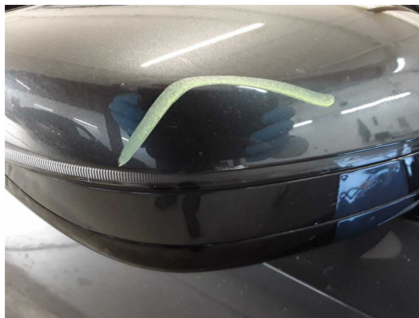
Dommage #5: Rétroviseur droit: Capuchon - Éraflé - Réparation intelligente
