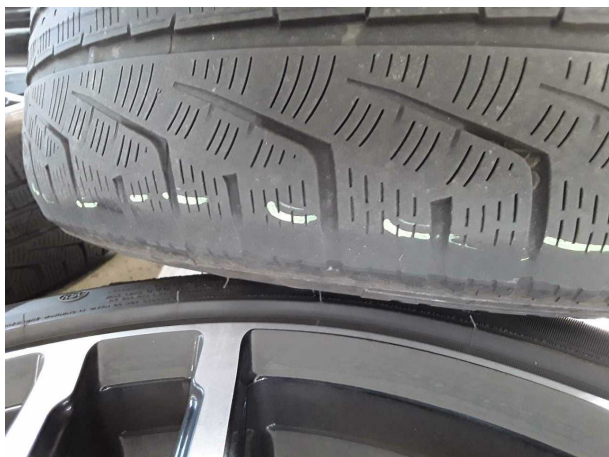
Damage #1: 2nd wheel set: 2 tyres (innen abgefahren) - Worn - No deduction
