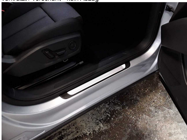
Beschädigung #3: Verkleidungen/Abdeckungen: Einstieg vorn rechts - Delle(n) - erneuern
