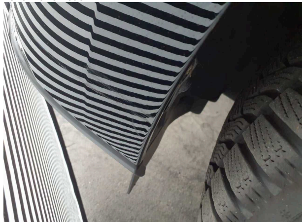
Beschädigung #3: Stossfänger vorn: Stossfänger mit Parktronic - verformt - erneuern
