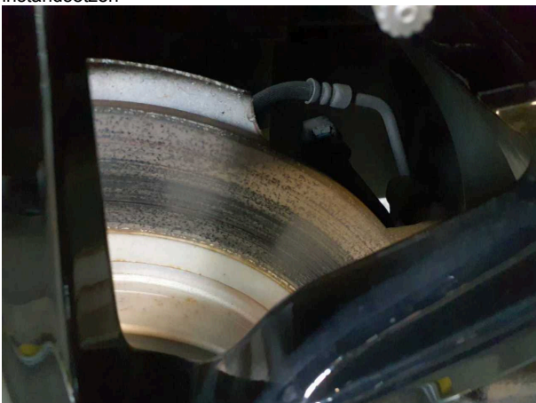
Beschädigung #2: Bremsanlage: Bremsscheiben und Beläge hinten - Korrosion - erneuern
