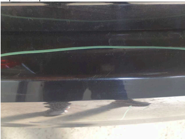
Domage #6: Pare-chocs arrière: Pare-chocs arrière - Eraflé - Réparer et repeindre
