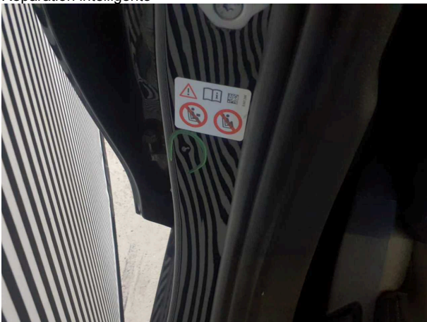
Domage #3: Seuil droit: Accès - Bosse, dommage peinture - Réparation intelligente
