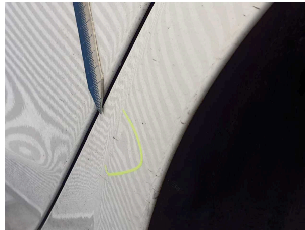
Beschädigung #1: Seitenwand links: Seitenwand - Delle(n) - sanft instandsetzen
