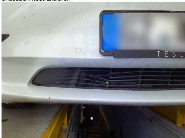
Beschädigung #6: Stossfänger vorn: Grill - gebrochen / gerissen - erneuern
