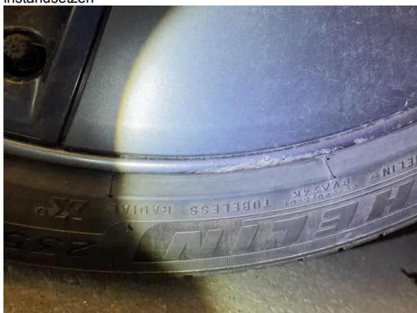
Beschädigung #2: Rad/Reifen: Leichtmetallfelge vorn links - Kratzer - Wertminderung
