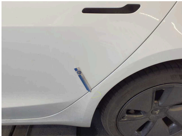
Beschädigung #1: Seitenwand links: Seitenwand - Delle(n) - sanft instandsetzen
