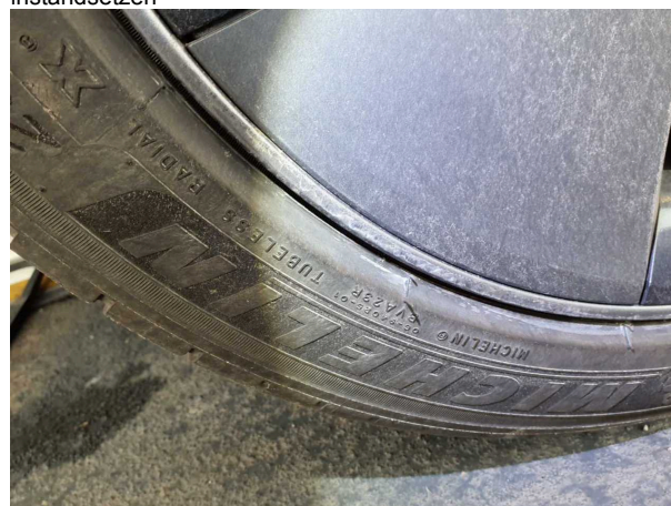
Beschädigung #3: Rad/Reifen: Leichtmetallfelge hinten rechts - Kratzer - Wertminderung
