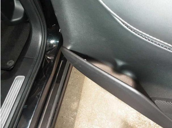
**Beschädigung #2:** Verkleidungen/Abdeckungen: Türverkleidung vorn rechts - Kratzer - Smart Repair
