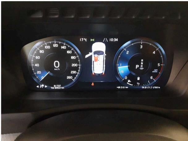
**Abbildung 9: Kombiinstrument**
