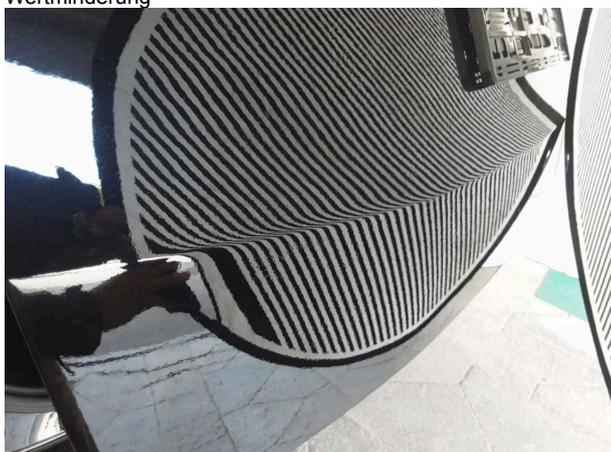
**Beschädigung #7:** Heckklappe/-tür: Heckklappe - Lackmangel - Smart
