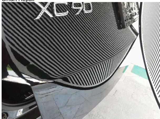
**Beschädigung #7:** Heckklappe/-tür: Heckklappe - Lackmangel -
