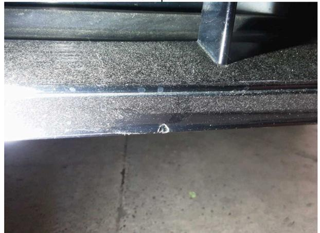
**Beschädigung #3:** Stossfänger vorn: Spoiler - Steinschlag - Smart Repair
