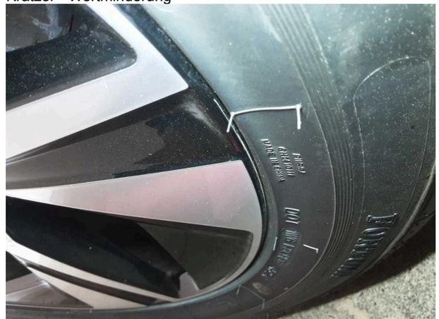
**Beschädigung #6:** Rad/Reifen: Leichtmetallfelge vorn rechts - Kratzer - Wertminderung
