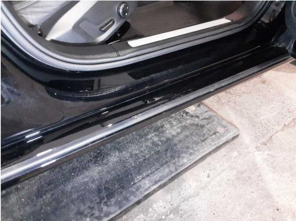
**Beschädigung #4:** Karosserie: Türdichtung vorn rechts - gebrochen / gerissen - erneuern
