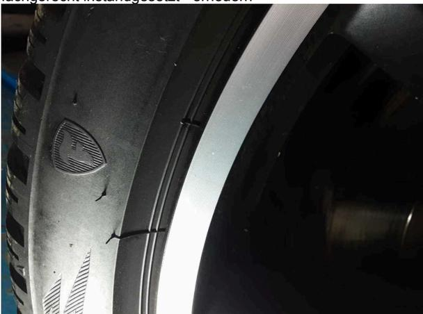
**Beschädigung #11:** Rad/Reifen: Leichtmetallfelge hinten rechts - nicht fachgerecht instandgesetzt - erneuern
