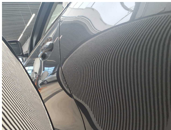
Dommage #1: Porte ArG: Porte - bosse(s) - Bon travail de réparation
