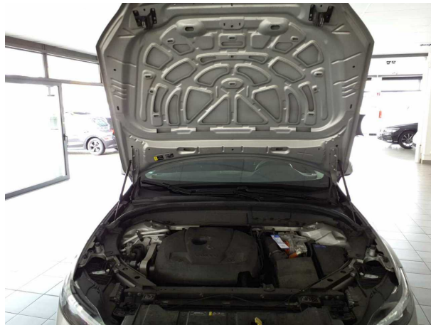
Beschädigung #2: Motorhaube: Dämmmatte - fehlt - erneuern
