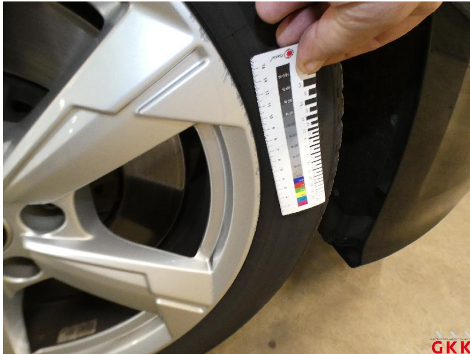
Bild 17 LM-Rad, vorne rechts, Materialabtrag, ersetzen
