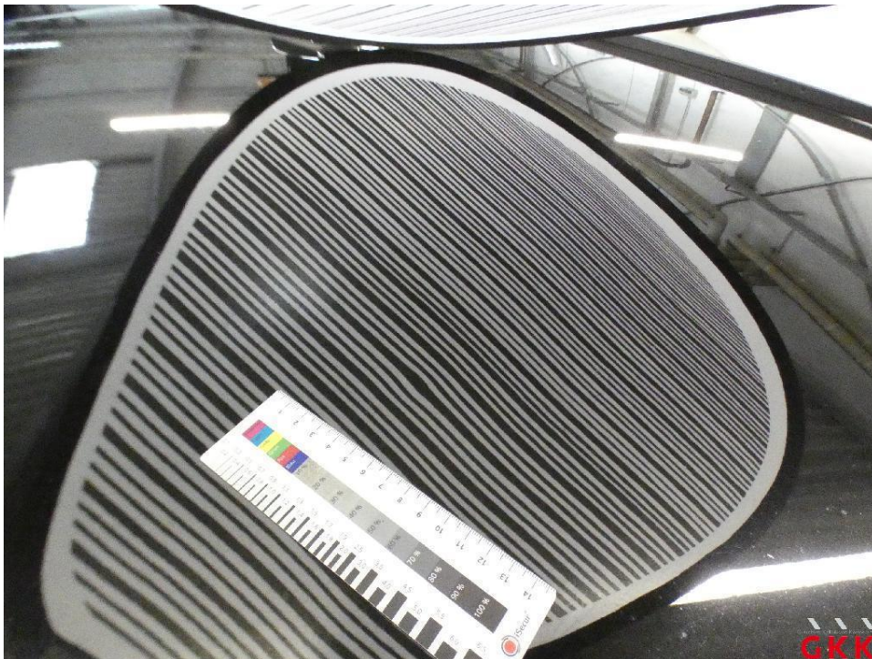
Bild 20 Dach, Mitte, beschädigt, kalt drücken
