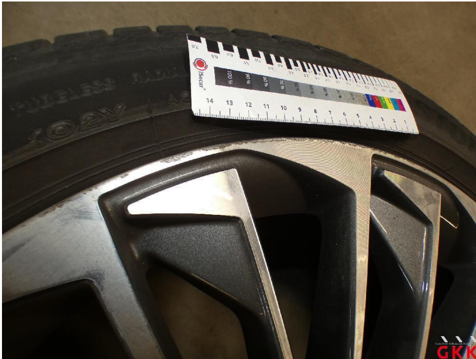
Bild 19 LM-Rad, 2 x beiliegend, Materialabtrag, ersetzen
