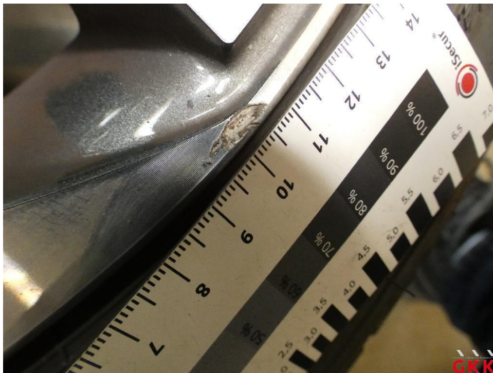
Bild 18 LM-Rad, 2 x beiliegend, Materialabtrag, ersetzen
