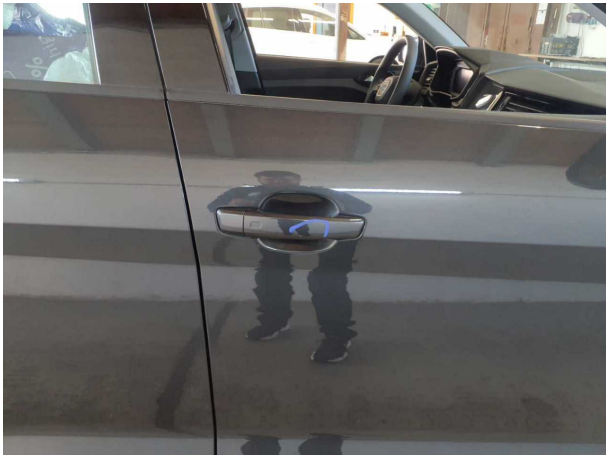
Beschädigung #1: Tür vorn rechts: Griff außen - verkratzt / verschürft - Smart Repair
