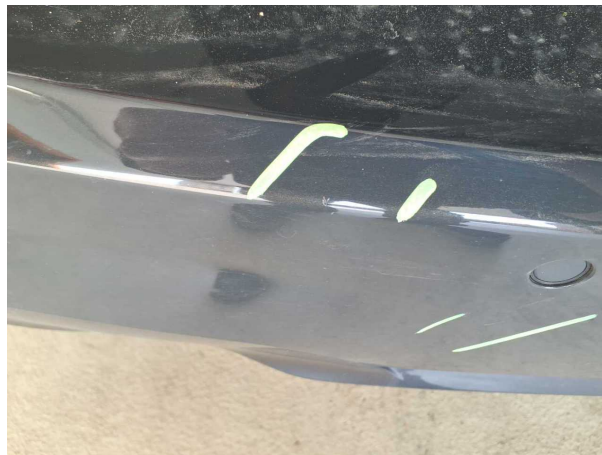
Domage #7: Pare-chocs arrière: Pare-chocs arrière - Eraflé - Réparation intelligente
