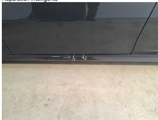
Domage #9: Seuil gauche: Habillage - Eraflé - Réparation intelligente
