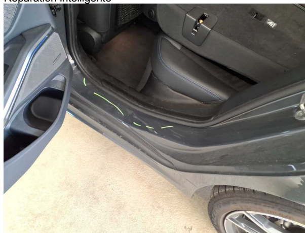
Domage #8: Panneau latéral arrière gauche: Accès - Eraflé - Réparation intelligente
