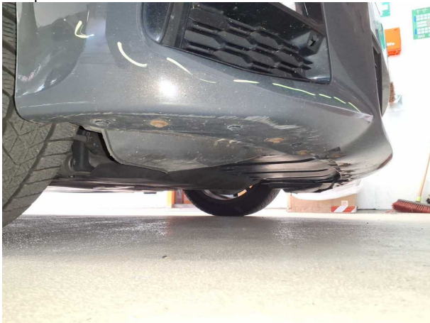
Domage #13: Pare-chocs avant: Pare-chocs avant - Déformé - Remplacer
