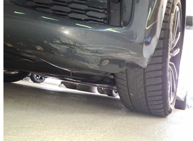
Domage #13: Pare-chocs avant: Pare-chocs avant - Défor... - Remplacer
