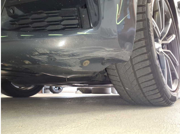
Domage #13: Pare-chocs avant: Pare-chocs avant - Déformé - Remplacer
