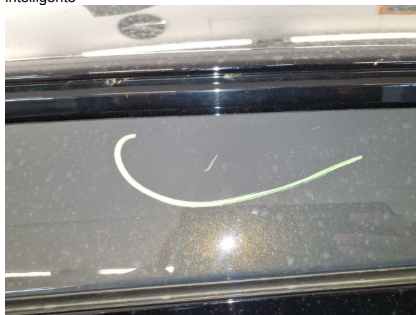
Domage #11: Toit: Rail de toit droit - Erafilé - Réparation intelligente
