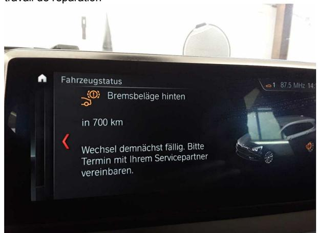
**Dommmage #6:** Système de freinage: Disques de frein et plaquettes arrière (Laut Anzeige) - Usé - Remplacer
