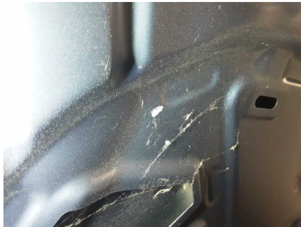
Beschädigung #1: Motorhaube: Motorhaube (Innen) - Kratzer - Smart Repair
