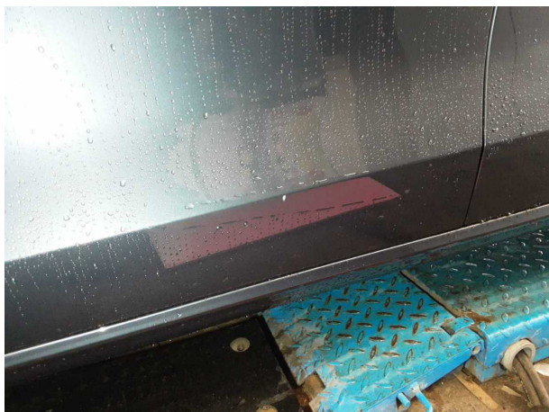
Beschädigung #5: Tür vorn links: Tür - Kratzer - Smart Repair
