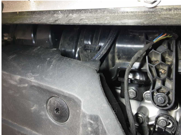
Beschädigung #3: Motor: Motorabdeckung oben / Blende - Marderschaden - erneuern
