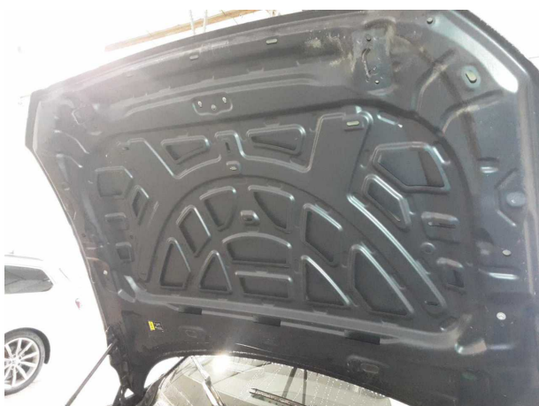
Beschädigung #6: Motorhaube: Dämmmatte - fehlt - erneuern
