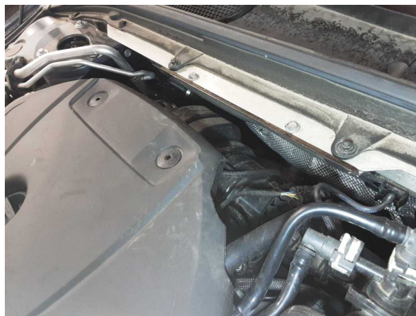
Beschädigung #3: Motor: Motorabdeckung oben / Blende - Marderschaden - erneuern
