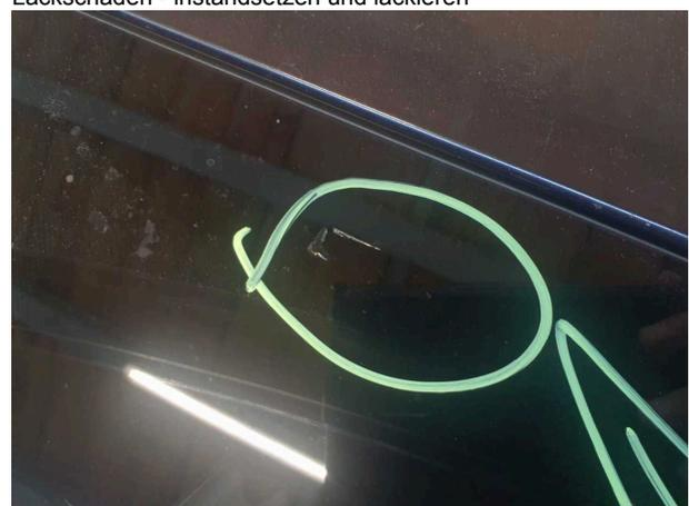
**Beschädigung #10:** Verglasung: Frontscheibe mit Spurhalteassistent (Mit Rissbildung) - Steinschlag - erneuern
