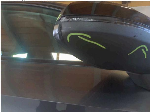
**Beschädigung #4:** Außenspiegel rechts: Spiegelgehäuse - beschädigt - erneuern
