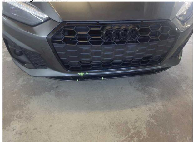
**Beschädigung #5:** Stoßfänger vorn: Spoiler - beschädigt - erneuern
