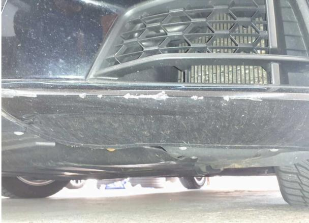
**Domage #9:** Pare-chocs avant: Pare-chocs avant - Eraflé - Réparer et repeindre
