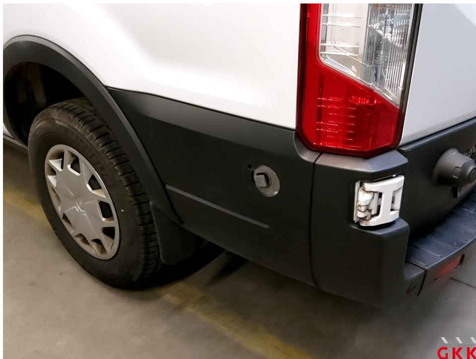
Bild 35 Anschlag / Hecktür links, fehlt, ersetzen
