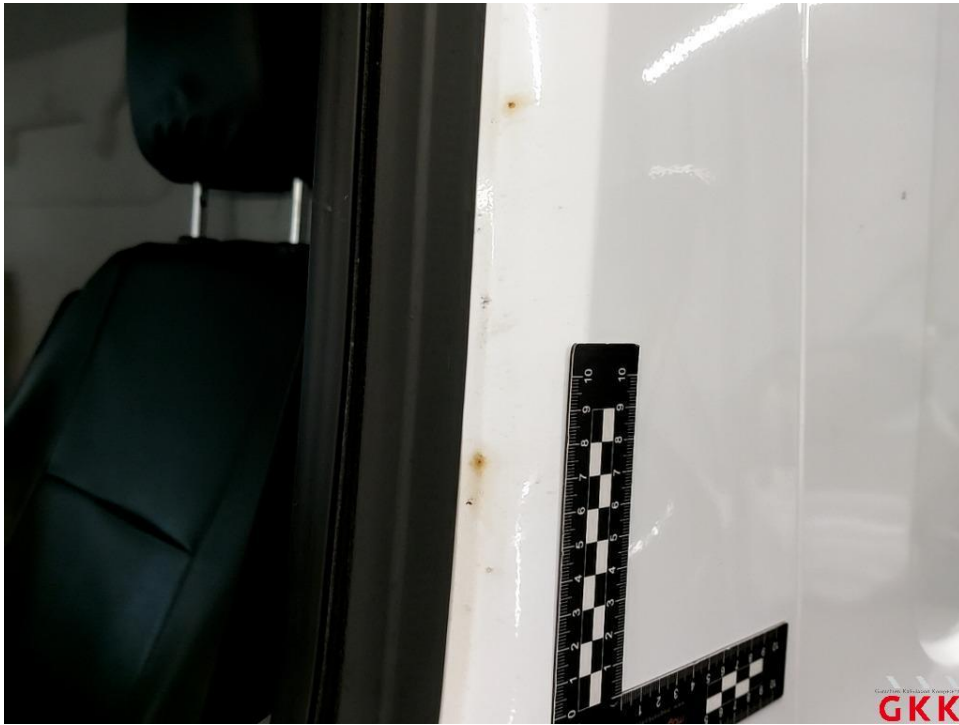
Bild 19 Tür vorne links, korrodiert, instand setzen - lackieren
