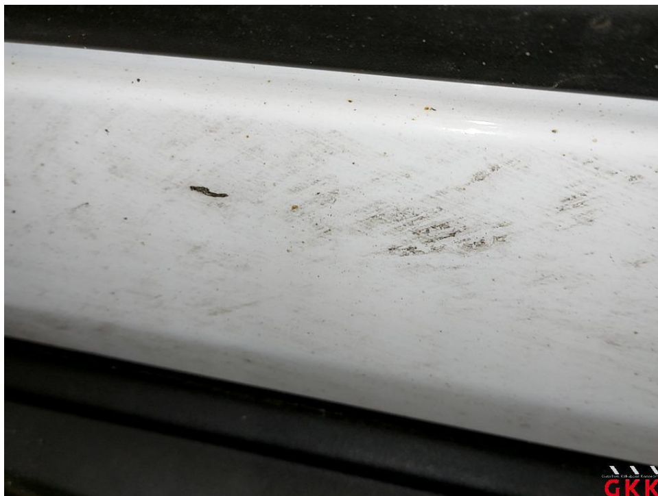
Bild 23 Fahrzeug, außen, Lackierung verwittert / matt, aufbereiten
