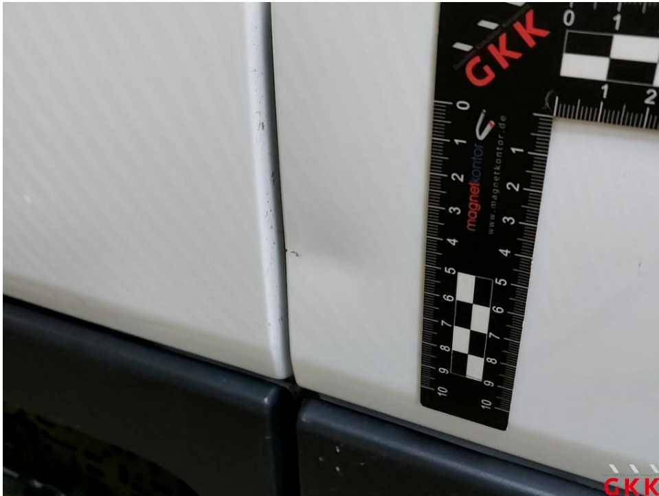
Bild 41 Hecktür rechts, beschädigt, Smartrepair
