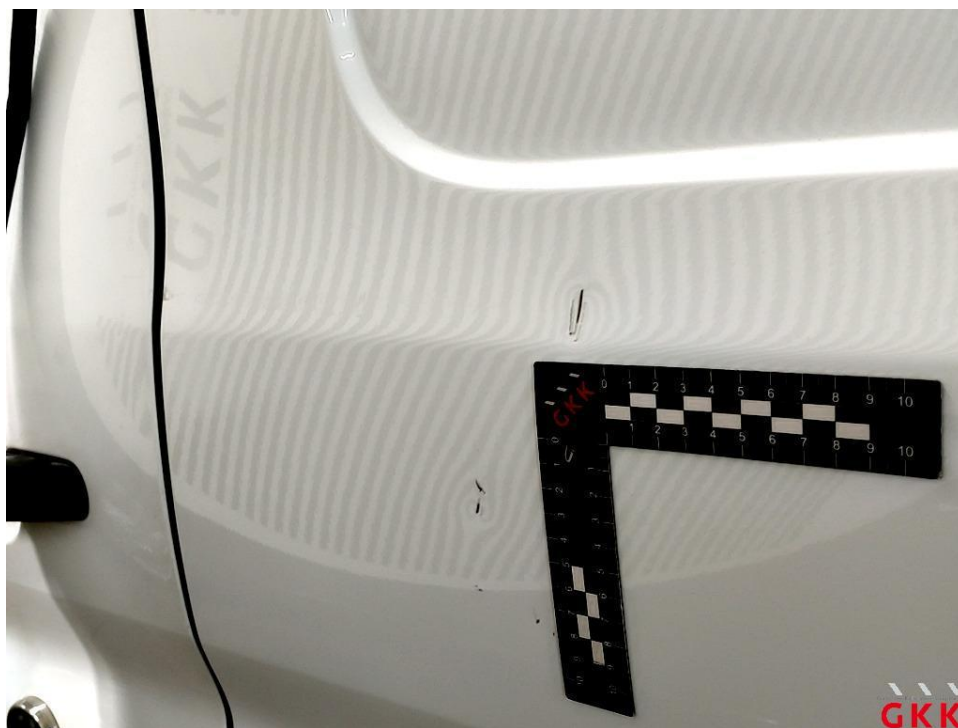
Bild 22 Seitenwand links, beschädigt, instand setzen - lackieren
