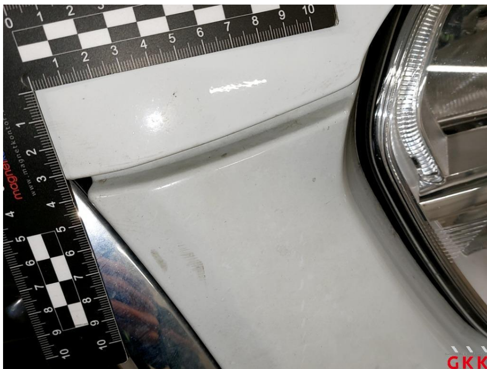
Bild 24 Fahrzeug, außen, Lackierung verwittert / matt, aufbereiten
