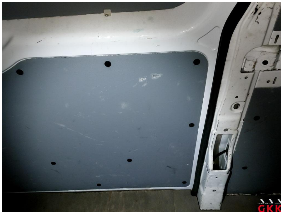
Bild 33 Schiebetür rechts, Innenverkleidung, beschädigt, ersetzen
