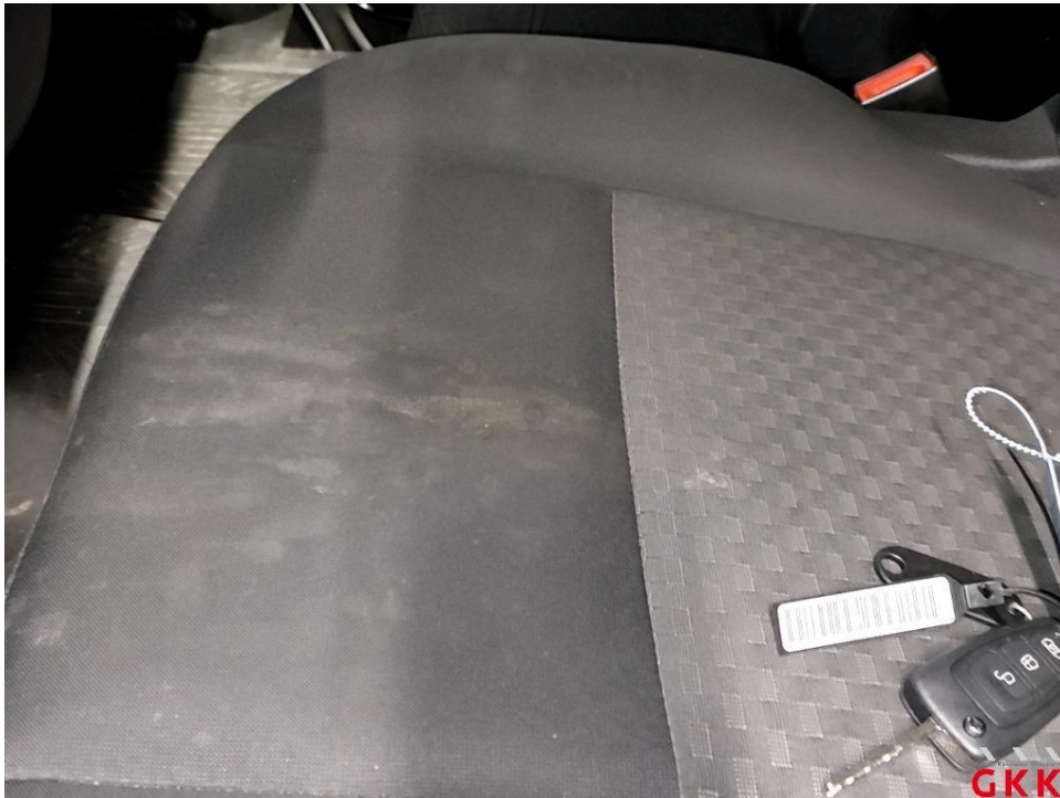
Bild 25 Fahrzeug, innen, verkratzt und verschmutzt, aufbereiten
