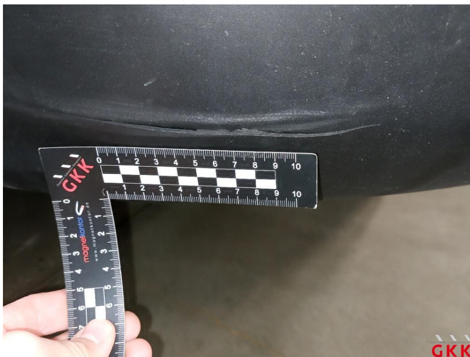
Bild 32 Stoßfänger vorne, Verkleidung -unlackiert-, verkratzt, ersetzen
