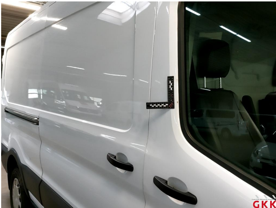
Bild 28 Tür vorne rechts, korrodiert, instand setzen - lackieren
