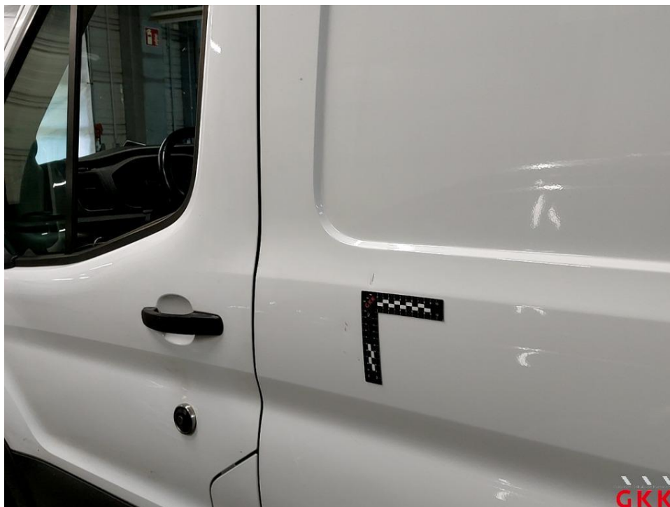
Bild 21 Seitenwand links, beschädigt, instand setzen - lackieren
