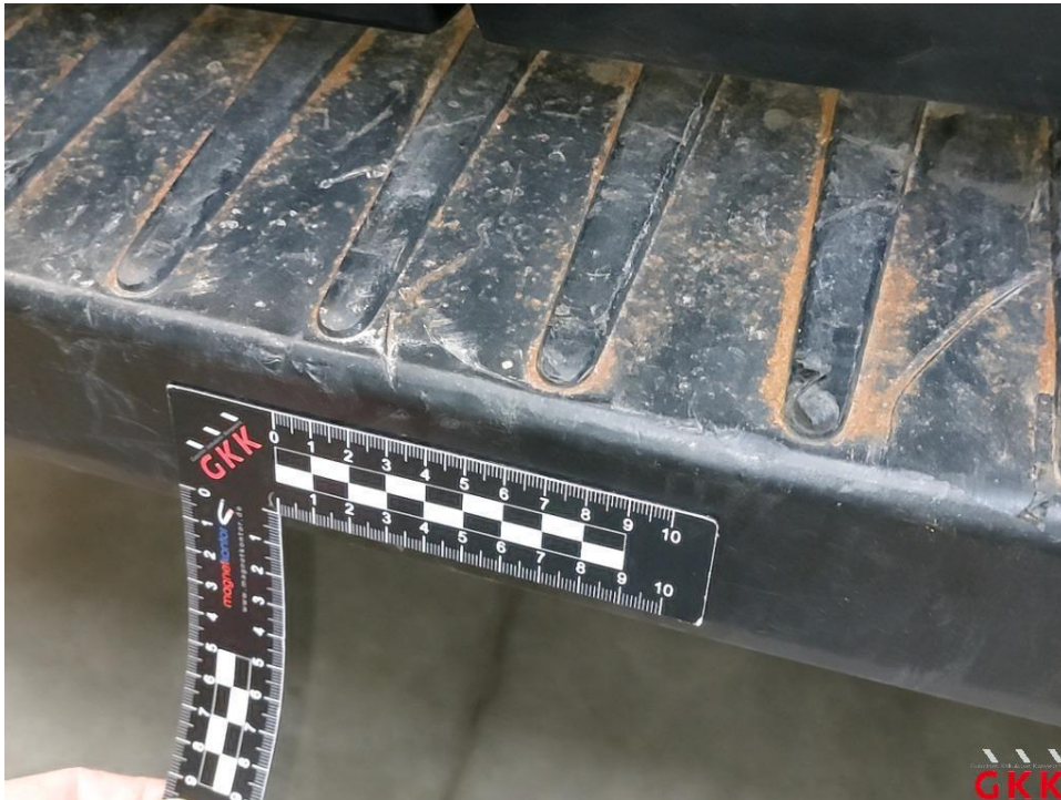
Bild 39 Stoßfänger hinten, Verkleidung -unlackiert-, beschädigt, ersetzen
