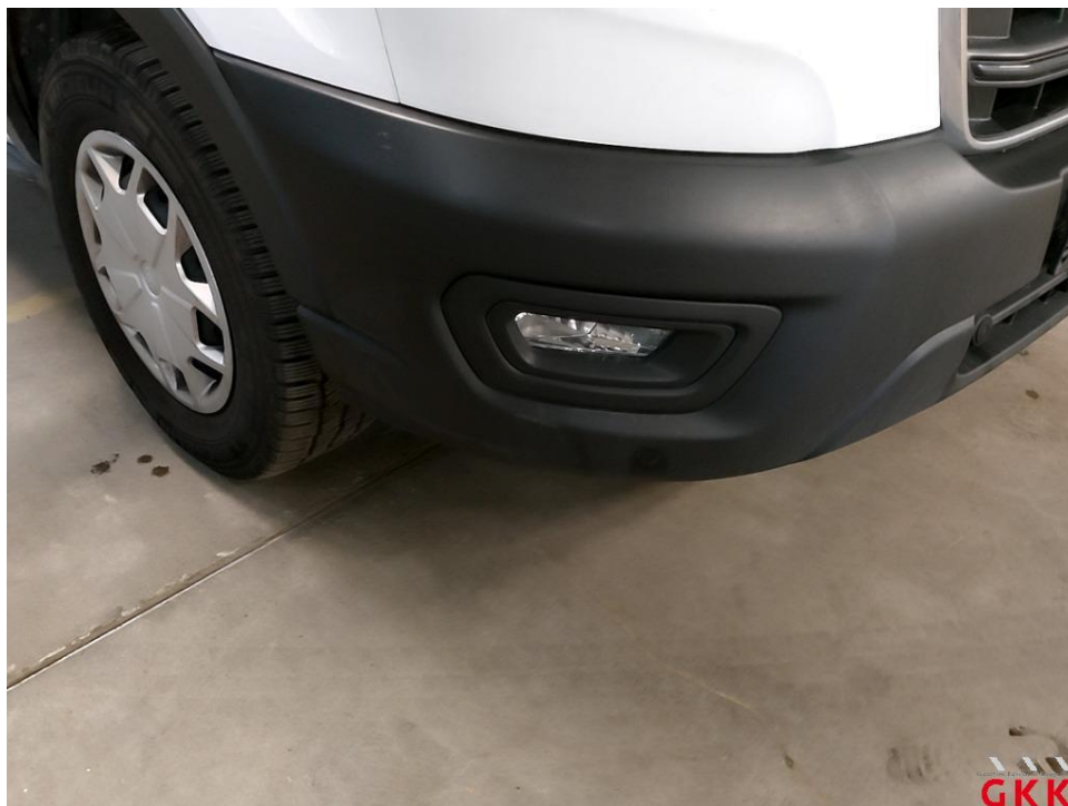
Bild 31 Stoßfänger vorne, Verkleidung -unlackiert-, verkratzt, ersetzen
