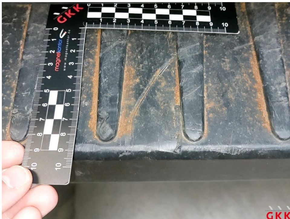
Bild 38 Stoßfänger hinten, Verkleidung -unlackiert-, beschädigt, ersetzen
