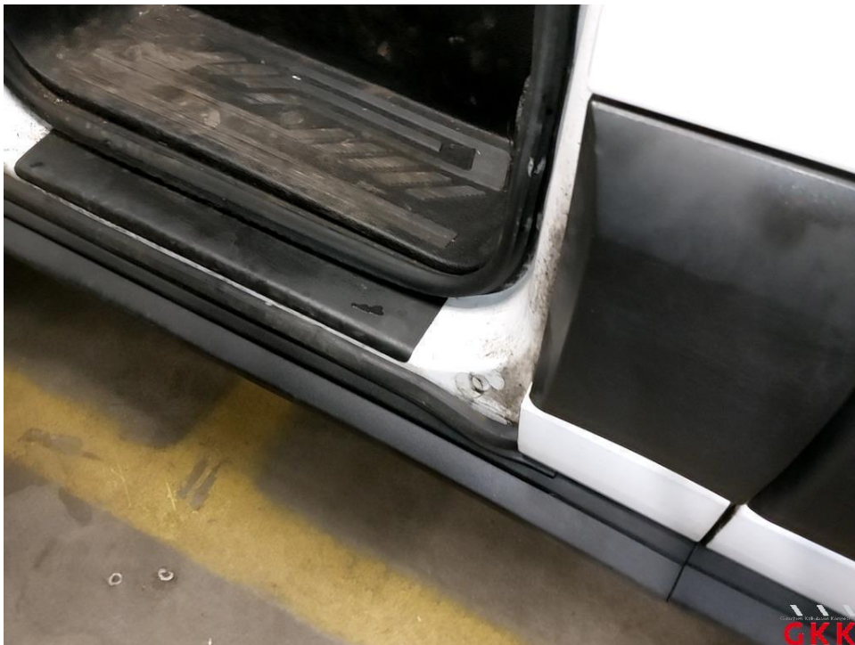
Bild 42 Tür vorne links, Dichtung -Einstieg-, lose, ersetzen
