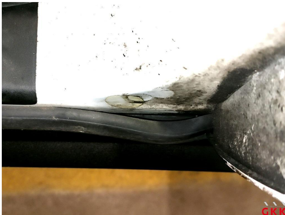
Bild 43 Tür vorne links, Dichtung -Einstieg-, lose, ersetzen
