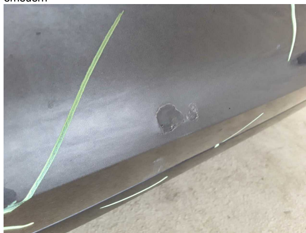
Beschädigung #3: Stossfänger hinten: Stossfänger hinten (Stark) - verkratzt / verschürft - erneuern
