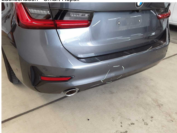
Beschädigung #3: Stossfänger hinten: Stossfänger hinten (Stark... verkratzt / verschürft - erneuern
